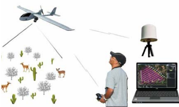
Esquema de operación del sistema: Firststar V2, computadora recibiendo telemetría y enviando definición de la ruta, antena, piloto y zona de estudio
