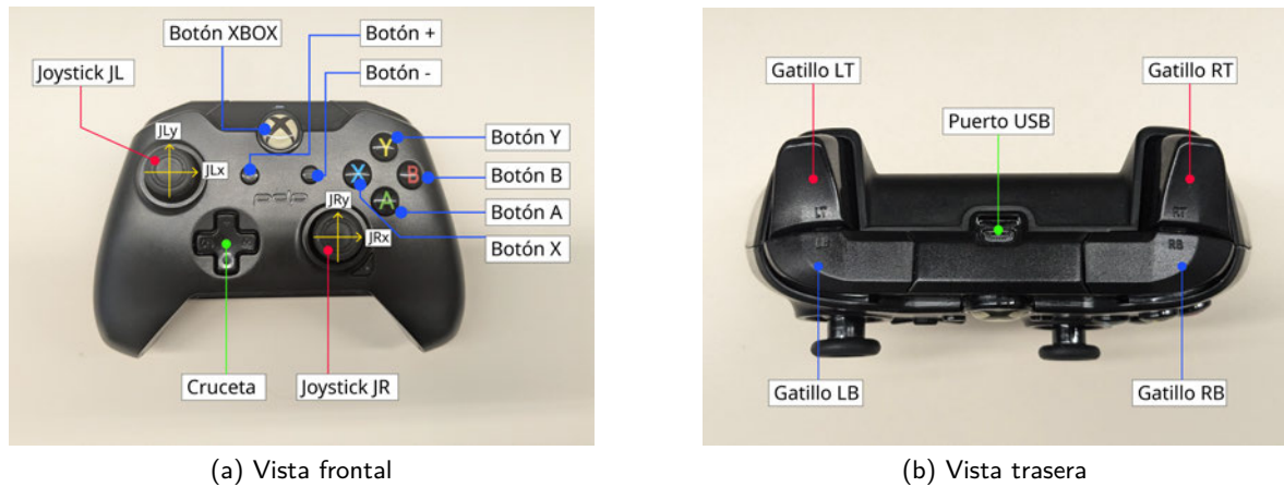
Figura 2.4: Imágenes del mando utilizado durante la teleoperación.
