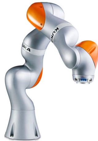
(b) Kuka LBR iiwa 14 R820. Fuente: 2
