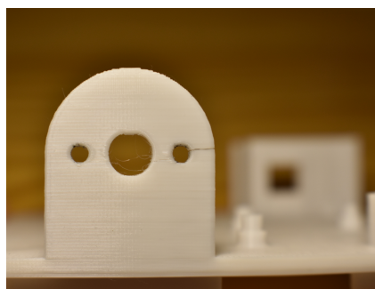
Figura B.15: Fractura del taladro para la sujeción del motor.
