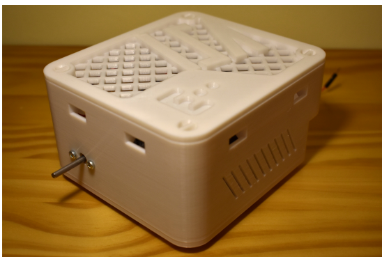
Figura 3.43: Vista del motor y de la ventilación lateral.
