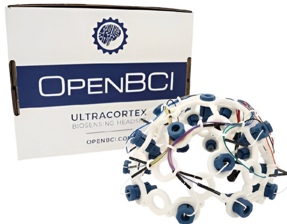
Figura 1.3: Casco diseñado para facilitar la adquisición de señales cerebrales de forma cómoda desarrollado por OpenBCI. Fuente: [3]
