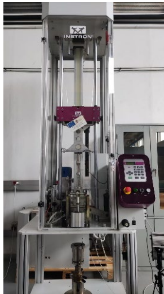
Figura 8 – Sistema de impacto vertical CEAS 9350 (Instron®)
