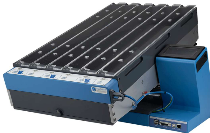
Figura 10. Cinta de correr para ratón. Imagen de la cinta de correr con seis carriles independientes utilizada para el protocolo de ejercicio programado.
