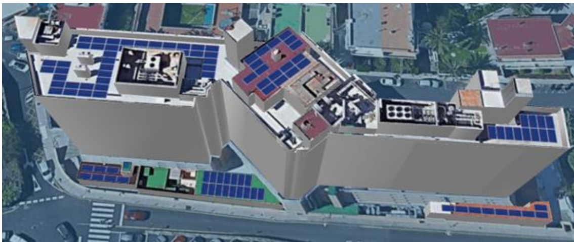
Figura 19. Disposición de los módulos fotovoltaicos realizado a través del software Designer – SolarEdge (fuente: elaboración propia).
