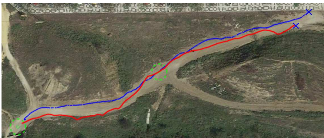
FIGURA 4.27: Comparación entre los caminos seguidos con navegación reactiva [86] y aprendizaje por refuerzo en líneas azules y rojas, respectivamente.
