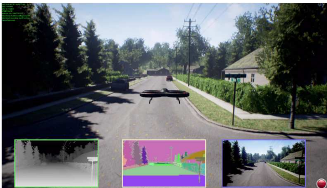
FIGURA 2.8: Airsim simulando el vuelo de un drone [57].
