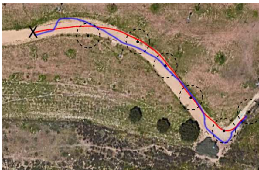
FIGURA 5.21: Primer y segundo experimento de navegación con Andábata (líneas roja y azul, respectivamente) y los puntos de paso calculados (círculos negros). La posición inicial del robot está marcada con una equis.
