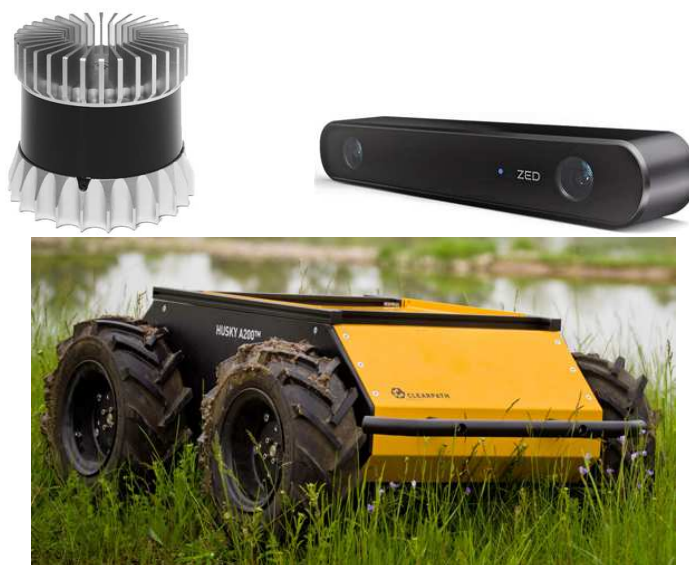
FIGURA 3.1: Fotografías de un LiDAR Ouster OS1-64 (arriba a la izquierda), una cámara estereoscópica ZED-2 (arriba a la derecha) y un UGV Husky de ClearPath Robotics (abajo).
