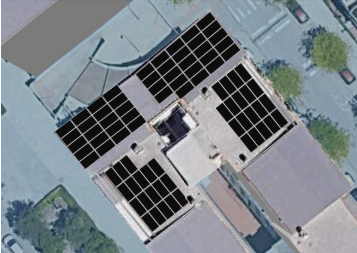
Ilustración 11: Simulación módulos colocados en orientación 1. Fuente: designer.solaredge.com
