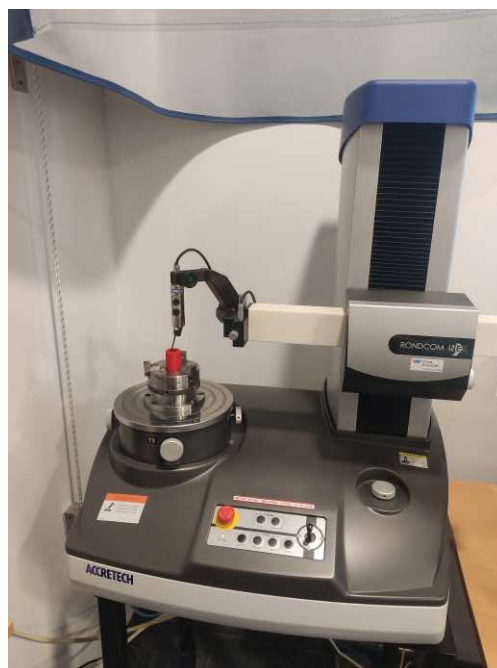
Figura 38: Evaluación defectos de forma de una de las probetas.
