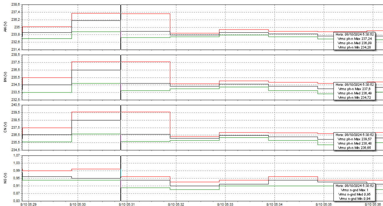
Figura 37. Gráfica de tensión máxima medida en el cuadro secundario CS-EDF A3-S2 SP
