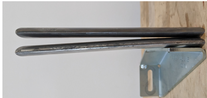
Figura 2.9: Vista frontal del ala sin deformación ( \rho = 0\% ) y ala muy deformada (azul) ( \rho = 4\% ) [17].
