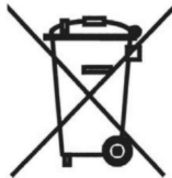
Imagen 86. Símbolo para marcaje de RAEE según Anexo V del *Real Decreto 110/2015, de 20 de febrero*
