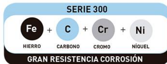
Imagen 66. Composición de los aceros inoxidables de la serie 300. Fuente: Hostelería3D. (s.f.). Qué es el acero inoxidable. Recuperado de: https://hosteleria3d.com/que-es-el-acero-inoxidable/
