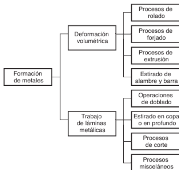
Imagen 73. Clasificación de las operaciones de formado de metales. Fuente: Groover, M. P. (2007). Fundamentos de manufactura moderna: materiales, procesos y sistemas (3ª ed., p. 379). McGraw-Hill.
