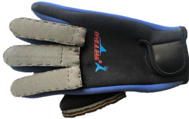
Figura 37 - Guante con los sensores integrados en dedos índice, corazón, anular y pulgar.
