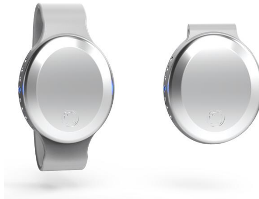
Figura 21 – Wearable para la salud llamado AerBetic para el control del azúcar en sangre del usuario. A la izquierda se puede ver el modelo de muñeca y a la derecha el modelo de colgante.
