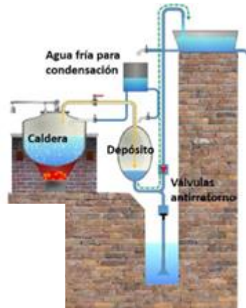
Figura 6: Esquema que muestra el funcionamiento de la máquina de vapor de Savery [6].
