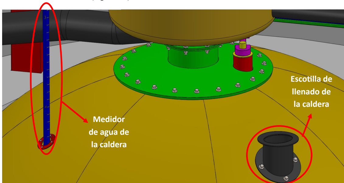
Figura 96: Escotilla de llenado y medidor de la altura del agua, colocados sobre la cúpula de la caldera.
