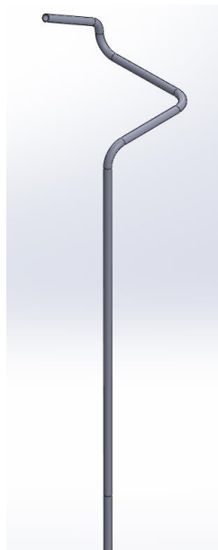
Figura 50: Sub-ensamblaje 01-10-00, respectivo a la Tubería de Recirculación entre el cilindro y la caldera de la máquina de vapor de Newcomen. Vista general completa.
