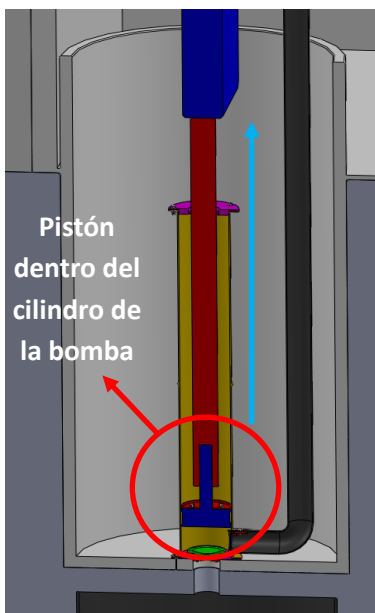
Figura 107: Detalle de la bomba del interior del edificio y desplazamiento de su pistón, durante la fase de carga.
