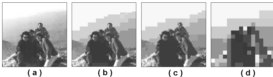
Figura 2.7: Segmentación por división y mezclado a distintos niveles de resolución: a) imagen original; b) segmentación en el nivel 256 \times 256 ; c) segmentación en el nivel 64 \times 64 ; d) segmentación en el nivel 16 \times 16 .
