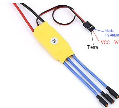
Figura 14. Ejemplo de un ESC visto desde fuera. Pueden apreciarse los 3 pines para el control del ESC. Negro tierra, rojo alimentación y blanco por donde debe ir las señales PWM. Fuente: [21]
