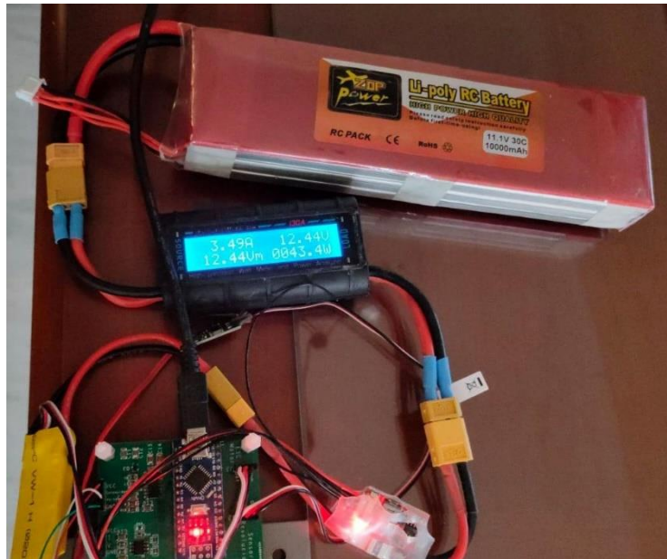
Figura 22. Módulo y conexión usada para la calibración de la tensión soportada y la intensidad consumida.
