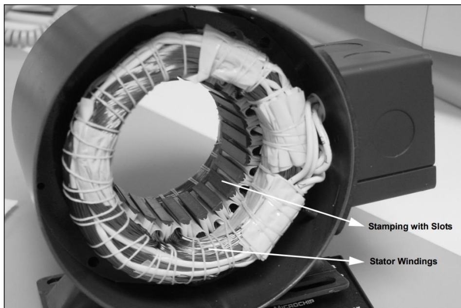
Figura 5. Estátor de un motor brushless. Fuente: [18]
