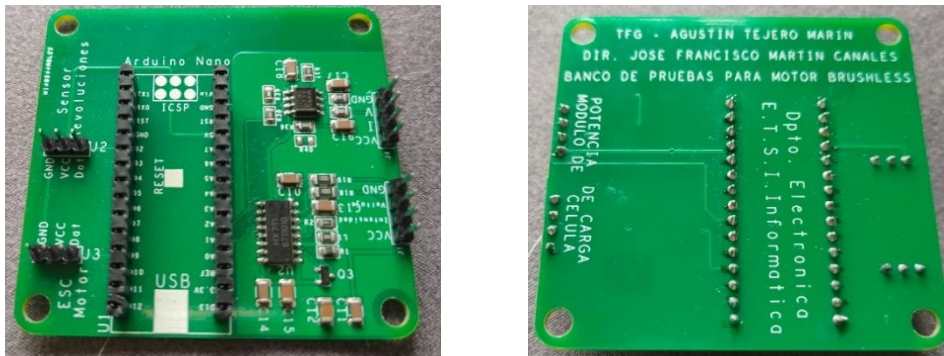
Figura 44. Placa para banco de pruebas brushless, anverso y reverso.
