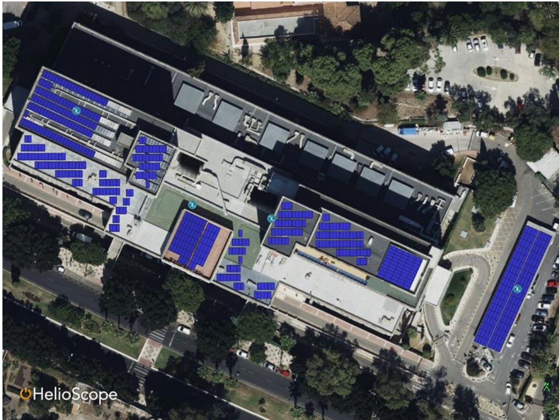
Figura 4.4: Simulación HelioScope Cubierta Hospital
