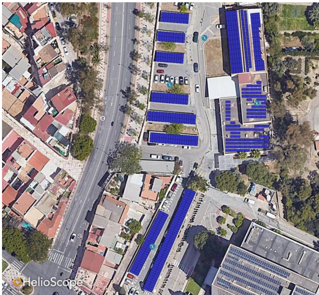
Figura 4.7: Simulación HelioScope Aparcamientos Hospital
