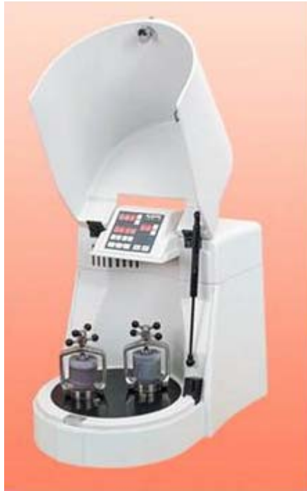
Figura 3.7. Imagen del molino planetario PULVERISETTE FRITSCH 7. En su interior se observan los dos contenedores de ágata.
