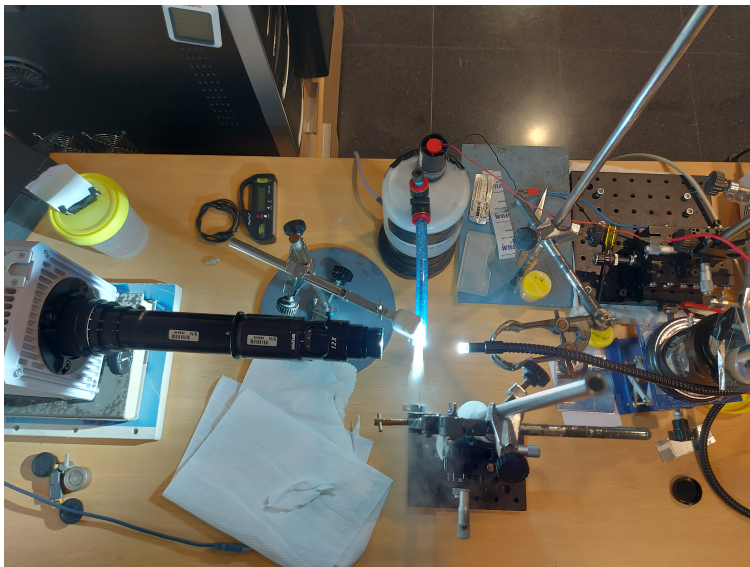
Figura 37: Montaje utilizado para grabar la corriente del aerosol.
