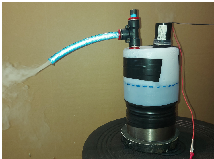
Figura 12: Generador del aerosol empleado para el presente trabajo.
