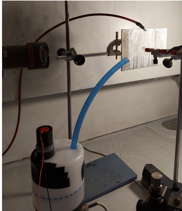
Figura 14: Generador del aerosol empleado sin el codo añadido.
