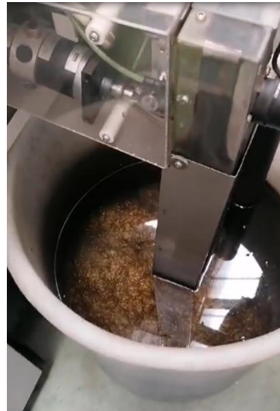
Figura 160: Vista interior del depósito de residuos del hilo de corte. Elaboración propia.
