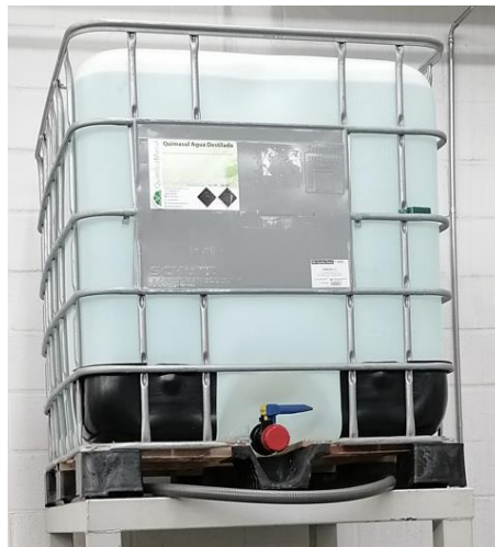
Figura 174: Depósito con agua destilada y desionizada. Elaboración propia.
