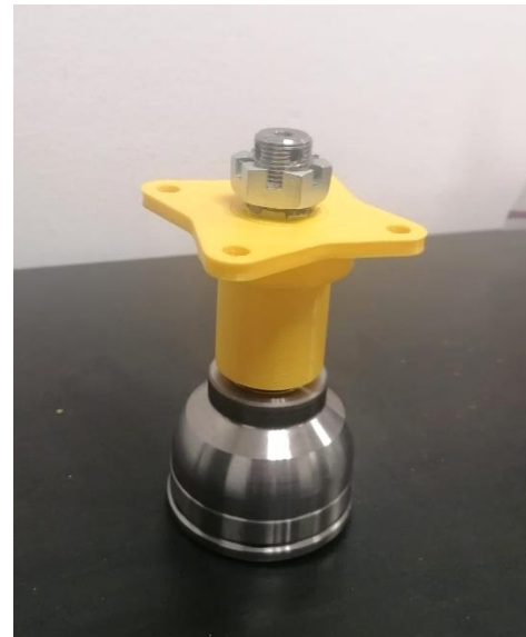
Figura 185: Bujes impresos atornillados a la homocinética. Elaboración propia.
