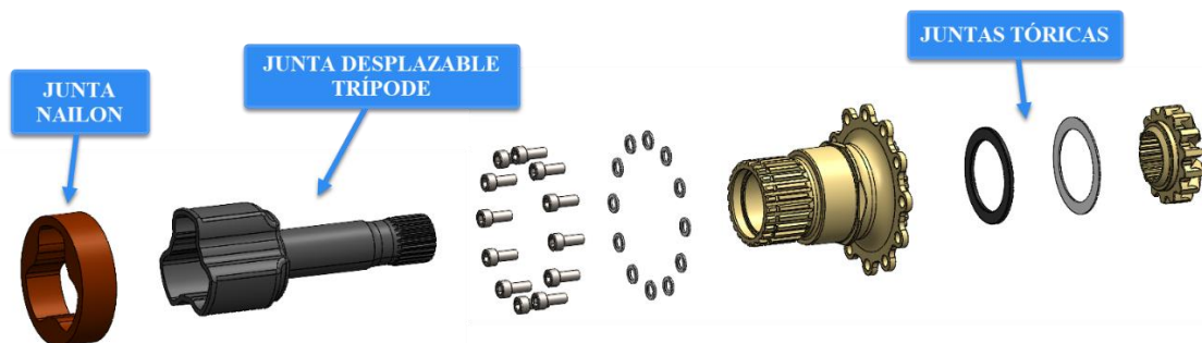
Figura 85: Explosionado más detallado del grupo diferencial. Elaboración propia.
