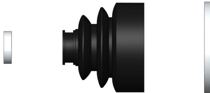
Figura 91: Guardapolvos con bridas metálicas de la junta desplazable de trípole. Elaboración propia.
