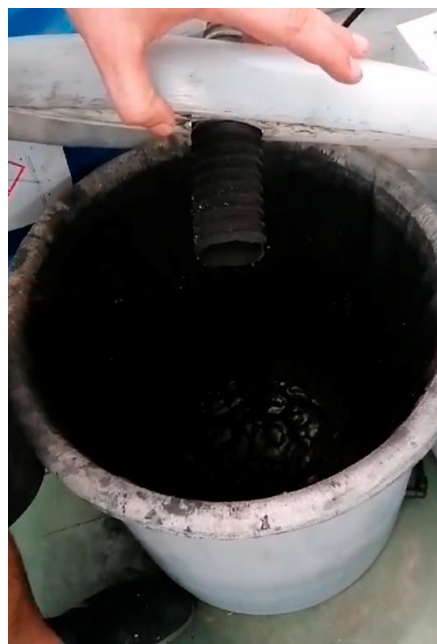
Figura 167: Residuo cracking procedente de la zona de trabajo y sistema de filtrado para su posterior reciclaje. Elaboración propia.
