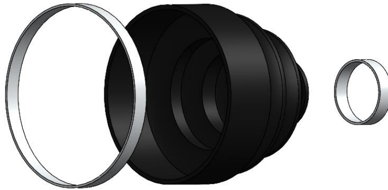
Figura 68: Vista de explosionado subensamblaje guardapolvos de la junta homocinética desplazable trípode. Elaboración propia.
