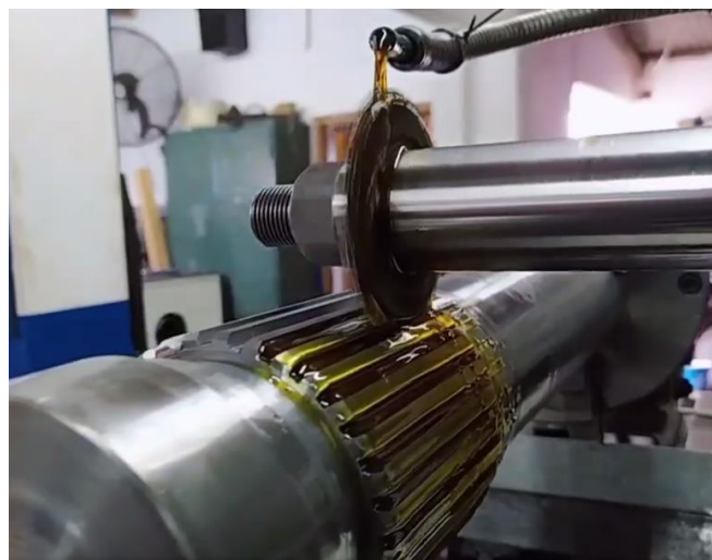
Figura 188: Mecanizado del estriado del palier de una retroexcavadora mediante un fresado en escuadra [32].
