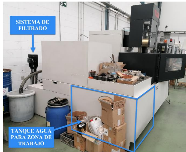
Figura 165: Localización del sistema de filtrado y del tanque de líquido dieléctrico en una erosionadora ONA AF35. Elaboración propia.
