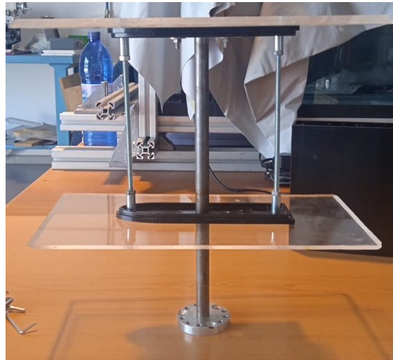
Figura 3.3: Soporte para el cuerpo de estudio en 2D. Se incluyen las placas laterales y la barra de sujeción (sin el modelo).
