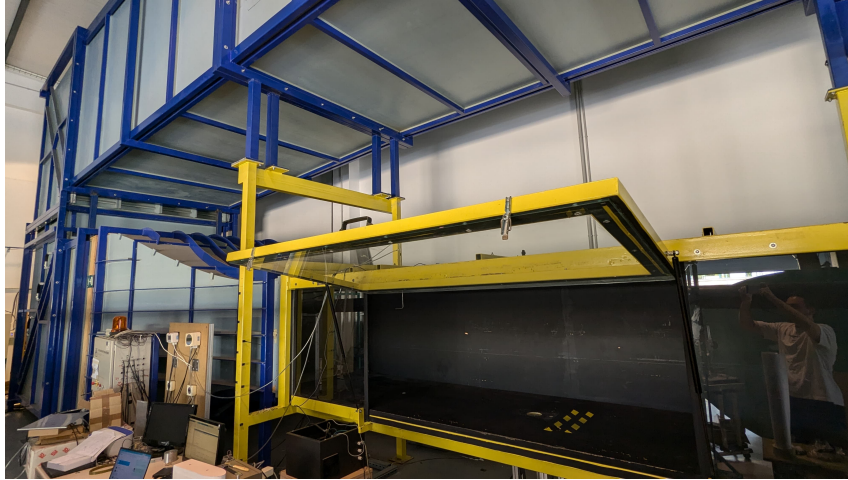
Figura 3.6: Túnel de viento en el que se han realizado los experimentos
