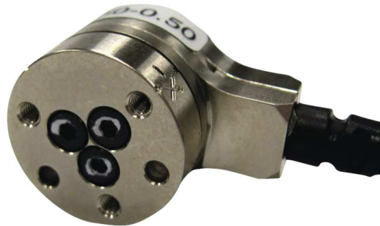
Figura 3.7: Célula de carga empleada en los experimentos. Modelo FTD-Nano17.
