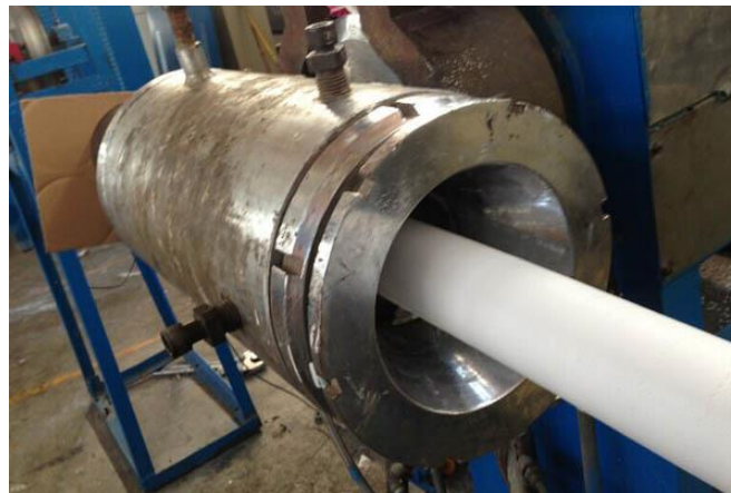
Figura 52. Proceso de moldeo por extrusión de silicona líquida (HTV 高温硫化硅橡胶三种成型工艺, 2022)
