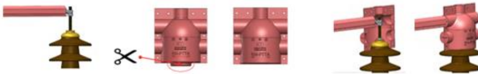
Figura 32. Proceso de instalación en pasatapas del RH-PPTA
