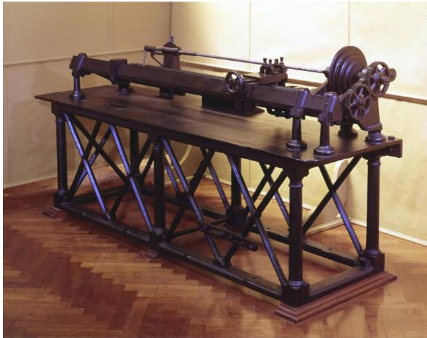
Figura 5.24. Torno de corte de tornillos de Henry Maudslay, 1800 [60].
