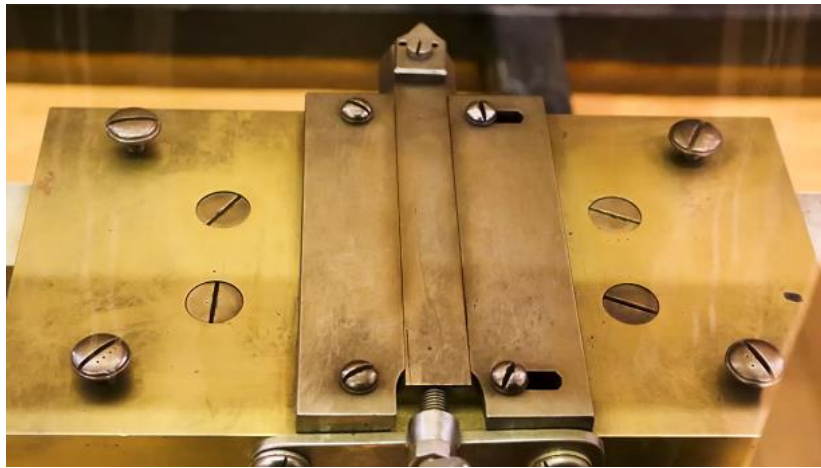
Figura 5.15. Portaherramientas fijado en el carro longitudinal. Captura de pantalla del vídeo “La máquina de 1751 que lo hizo todo” [50].
