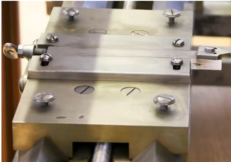
Figura 5.9. Carro longitudinal y portaherramientas. Captura de pantalla del vídeo “La máquina de 1751 que lo hizo todo” [50].
