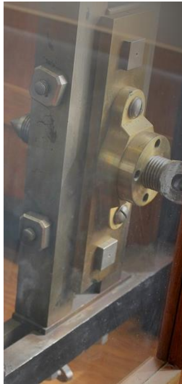
Figura 5.18. Detalle del tornillo para ajustar la pieza a mecanizar [45].
