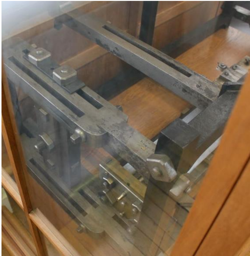
Figura 5.19. Soportes transversales de la estructura del contrapunto [45].
