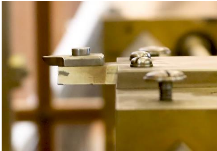
Figura 5.16. Detalle de la herramienta de corte; de tipo plaquita. Captura de pantalla del vídeo “La máquina de 1751 que lo hizo todo” [50].
