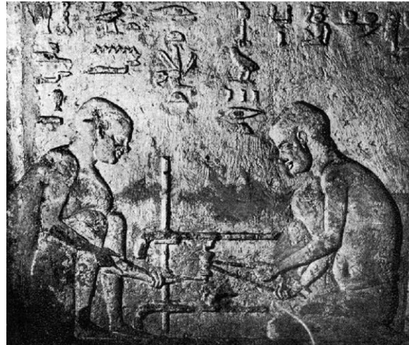
Figura 4.1. Tallado en bajorrelieve de un torno manual en la tumba de Petosiris (Egipto, siglo IV a.C.) [17].
