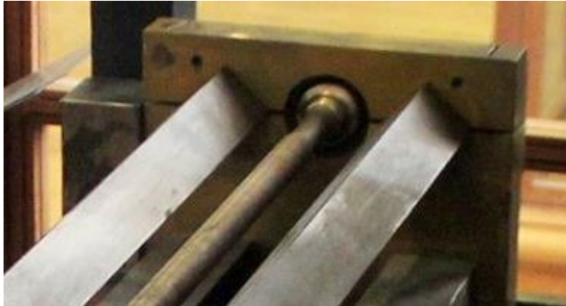
Figura 5.13. Conexión entre el extremo del husillo de avance y el casquillo [45].
