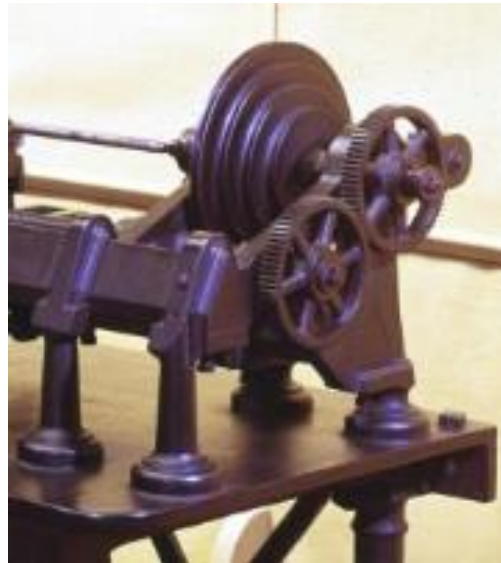
Figura 5.28. Detalle del sistema de engranajes del torno de Henry Maudslay, 1800. Imagen recortada [60].
