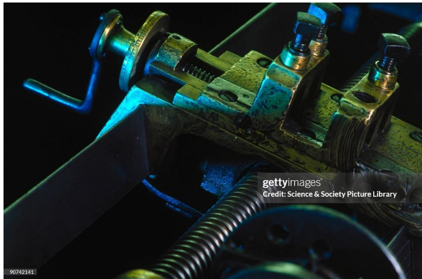
Figura 5.32. Detalle del carro y el portaherramientas [61].
