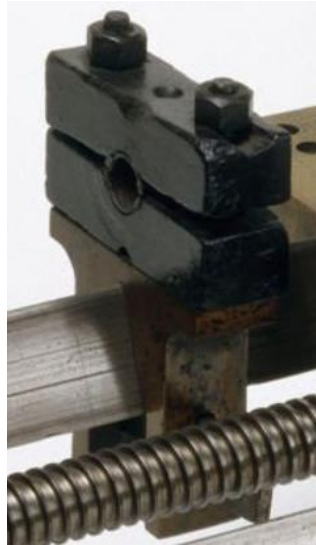
Figura 5.34. Soporte guía de la pieza a mecanizar. Imagen recortada [59].
