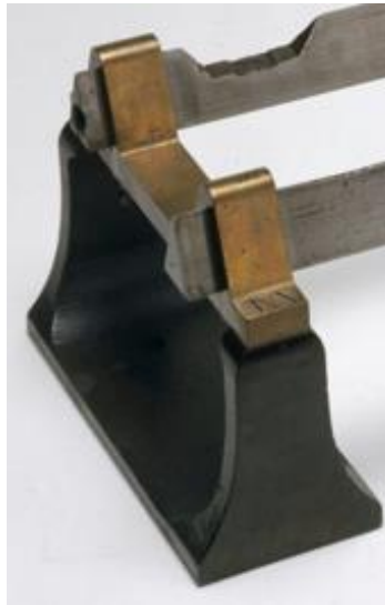
Figura 5.25. Detalle de un soporte del cuerpo del torno. Imagen recortada [59].
