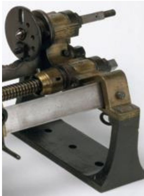
Figura 5.26. Detalle del soporte del cuerpo situado en el extremo del cabezal. Imagen recortada [59].
