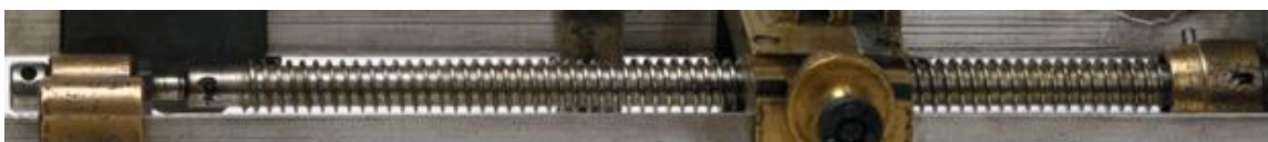
Figura 5.29. Husillo de avance. Imagen recortada [33].
