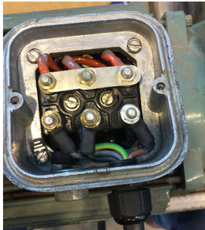
Fig.SU- 6 Cableado estrella-triángulo motor
