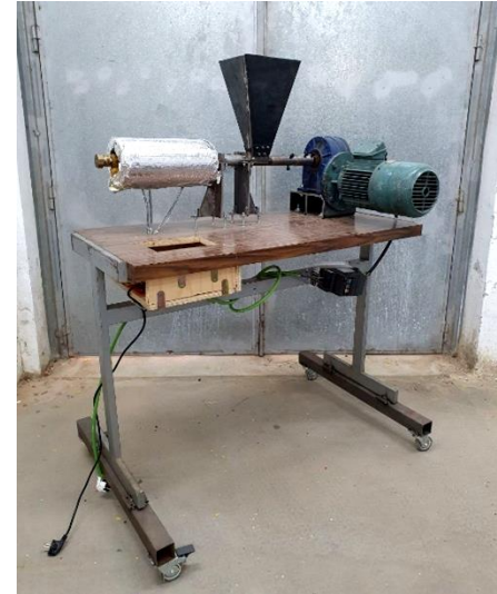
Fig. SU- 12 Izq. Extrusora básica de Precious Plastic; Dcha. Extrusora en desarrollo de MAREA Plastic
