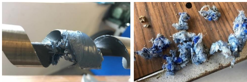
Fig.SU- 9. Izq. - Concentración de plástico fundido en el husillo; Dcha - Escamas fundidas de PET
