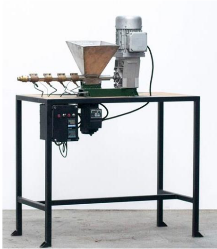
Fig. SU- 12 Izq. Extrusora básica de Precious Plastic; Dcha. Extrusora en desarrollo de MAREA Plastic
