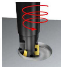
Figura 17: . Representación del taladrado helicoidal.
