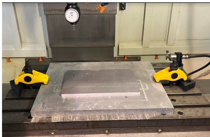
Figura 42: Decalaje inicial del Centro de Mecanizado
