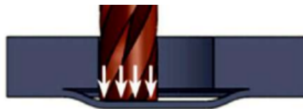
Figura 29: Representación de la distribución de carga axial en la última capa de material compuesto [99].
