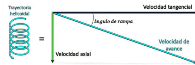
Figura 23: Descomposición de la velocidad de avance.
