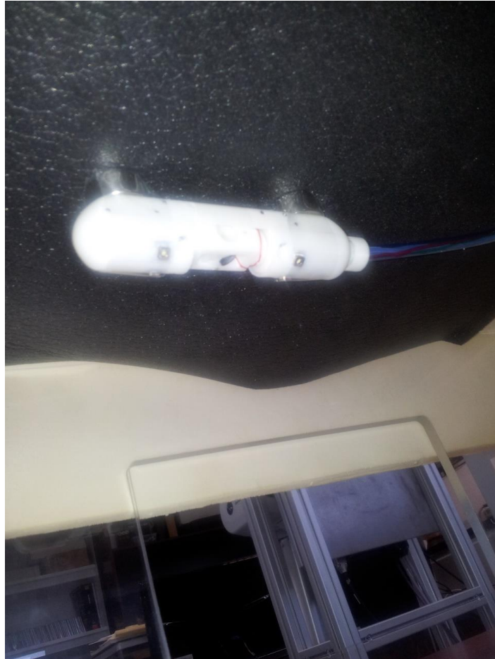
Figura 24: Mini-robot en el interior de la caja de metacrilato que simula la cavidad abdominal
