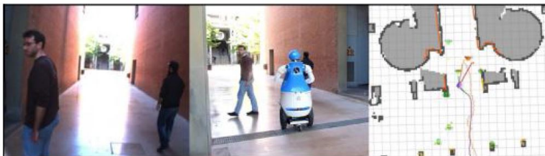
Figura 2.14: El robot Dabo acompañando a una persona hasta la meta deseada mientras navega en un escenario lleno de gente (imagen tomada de Ferrer and Sanfeliu [2014a]): (Izquierda) imagen capturada por la cámara del robot; (centro) el robot Dabo; (derecha) la GUI del robot. Los cilindros verdes corresponden a personas y el cilindro naranja corresponde al objetivo. Permiso por ELSEVIER 5483750554512
