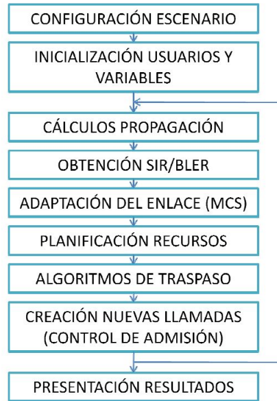
Figura A.1: Diagrama de bloques del simulador[101].
