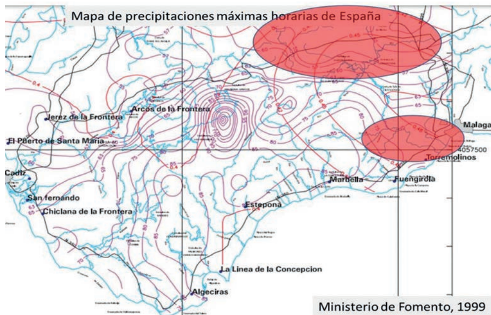
Figura 11. Áreas donde las previsiones del mapa de precipitaciones máximas de España han sido superadas. Elaboración propia
