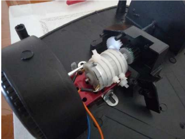
Ilustración 49. Transmisión y dirección del prototipo del vehículo
