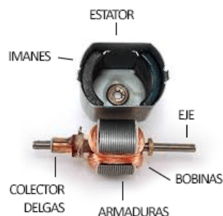
Ilustración 11. Partes de un motor CC
