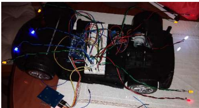
Ilustración 50. Sistema de iluminación instalado en el prototipo radiocontrol
