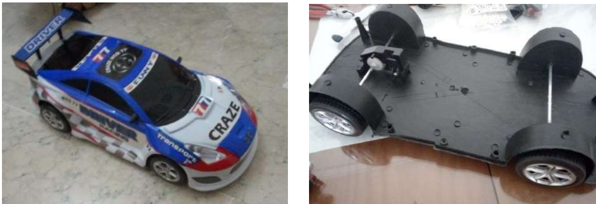
Ilustración 48. Carrocería e interior del prototipo del coche radiocontrol (47 x 20 cm)
