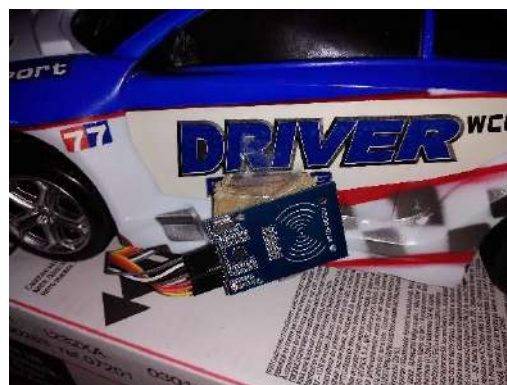
Ilustración 51. Lector RFID instalado en el prototipo del vehículo
