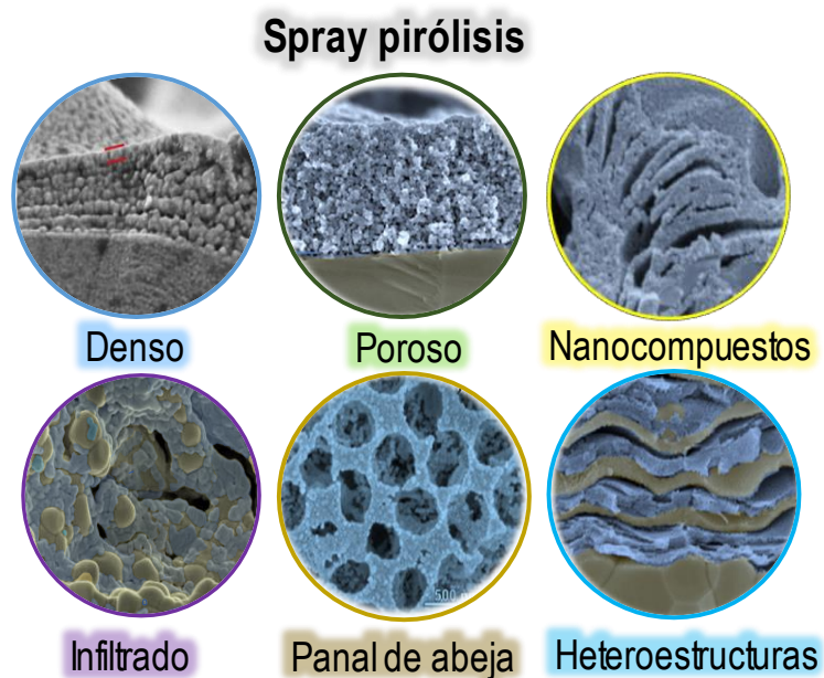
Figura 1. Diferentes microestructuras de los electrodos preparados por spray pirólisis [7].
