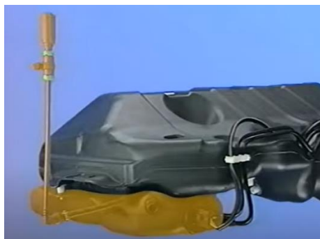
Figura 75: Tanque de aditivo
