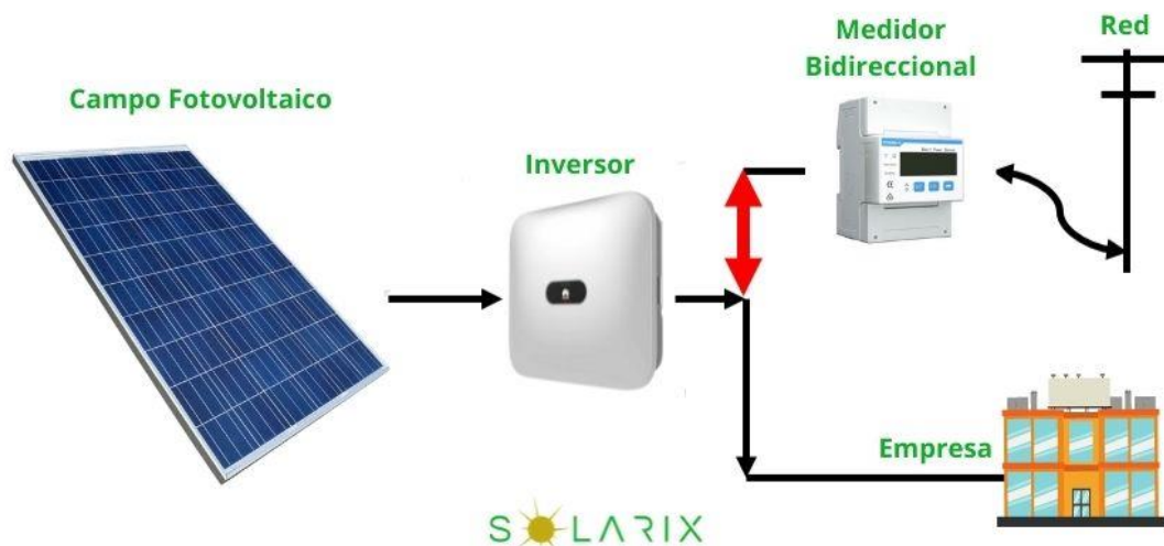
Ilustración 2: Esquema de funcionamiento bidireccional.
