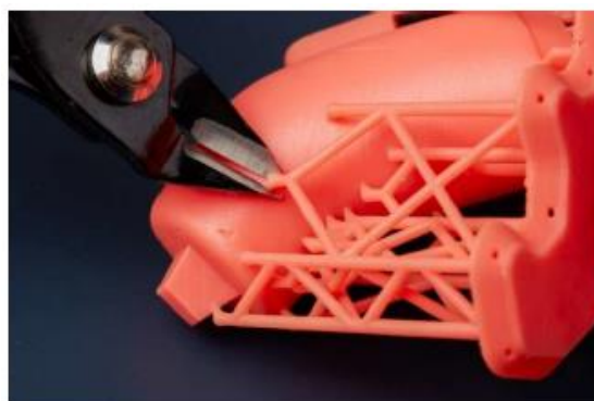
Figura 23: Eliminación manual de soportes de impresión. [17]
