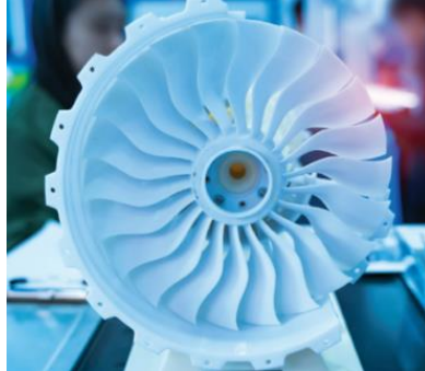
Figura 15: Turbina fabricada mediante FA. [10]
