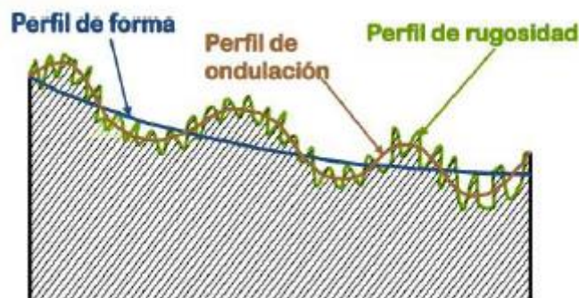
Figura 39: Perfil efectivo de una pieza. [25]
