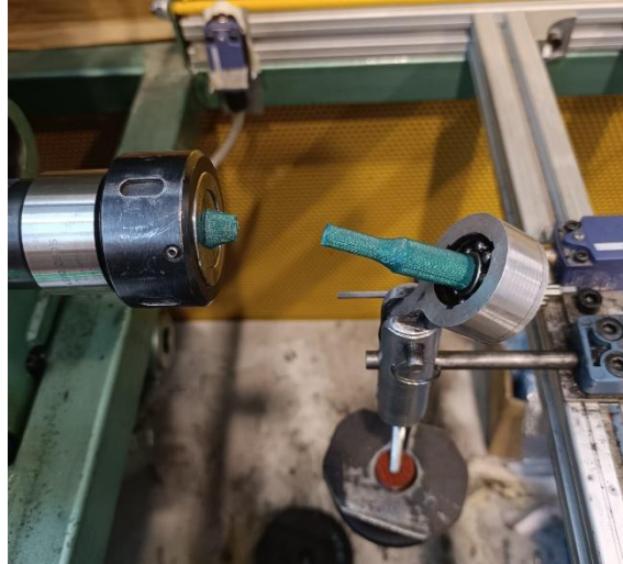
Figura 77: Rotura de probeta.
