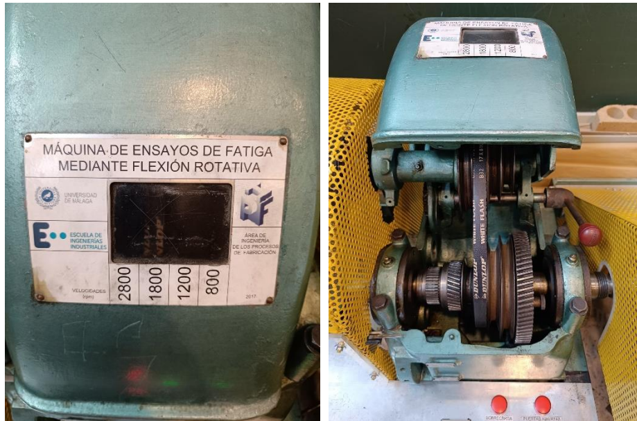
Figura 72: Velocidad fijada en 1800 rpm para el ensayo.
