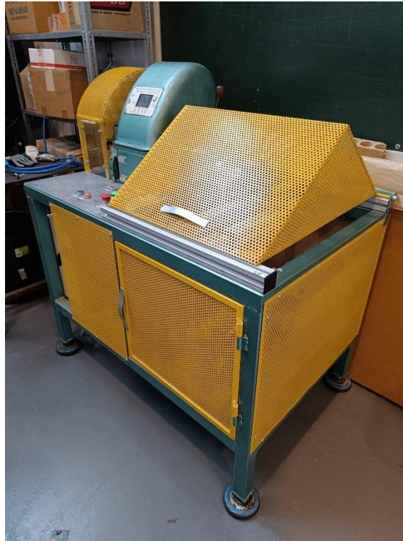
Figura 68: Máquina para ensayos de fatiga mediante flexión rotativa.
