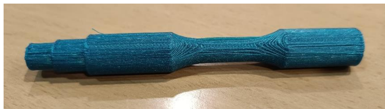
Figura 67: Imperfecciones de la probeta en la zona de contacto con el soporte.
