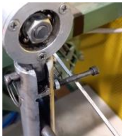
Figura 76: Sistema de parada automática de la máquina.
