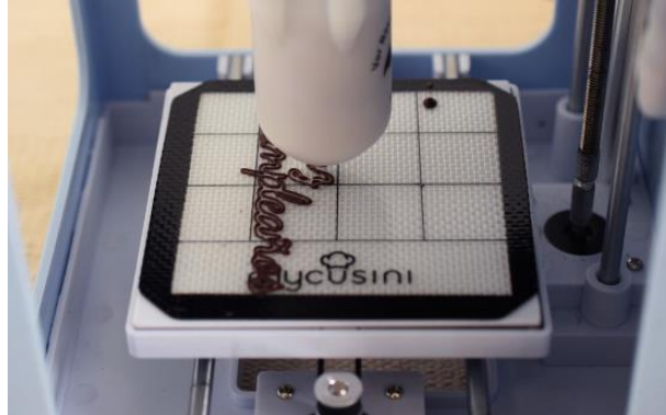
Figura 18: Detalle de chocolate creado con la impresora Mycusini mediante FA. [13]
