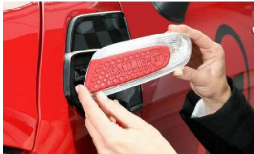
Figura 16: Detalle personalizado fabricado por la empresa Mini mediante FA. [11]
