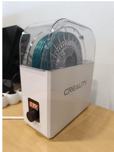
Figura 61: Secado de bobina de PLA.
