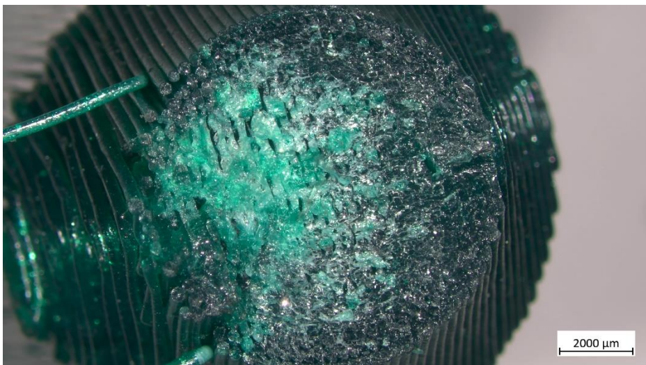
Figura 103: Fractografía de la Probeta 3 de la configuración B2_Fatiga_PLA_T60_R100_V40_TE215_E0.3_C3.
