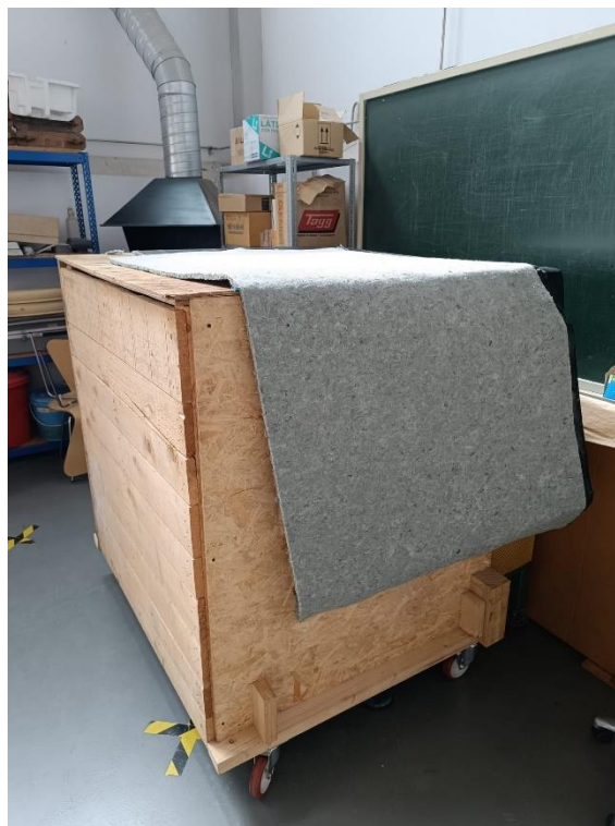
Figura 69: Caja de insonorización de la máquina de fatiga.
