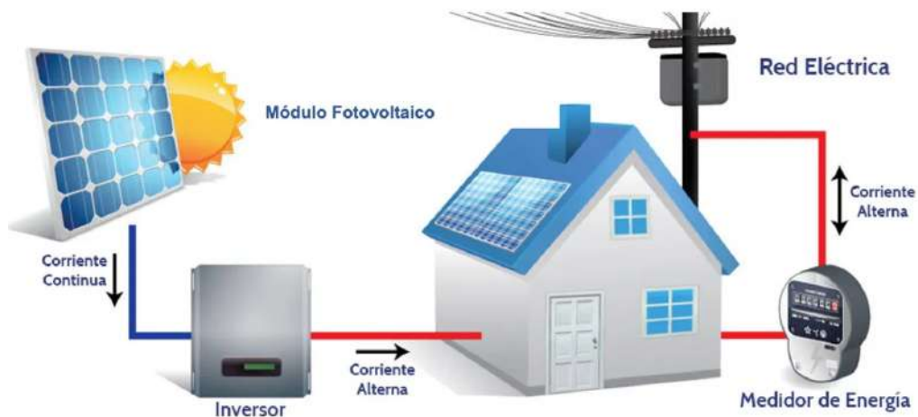
Figura 3.3: Esquema tipo de sistemas fotovoltaicos de autoconsumo [30]
