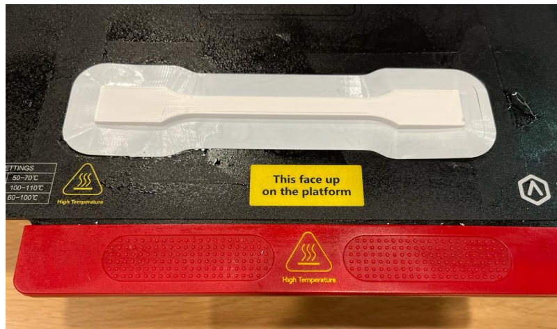
Figura 20. Probeta tras ser impresa.
