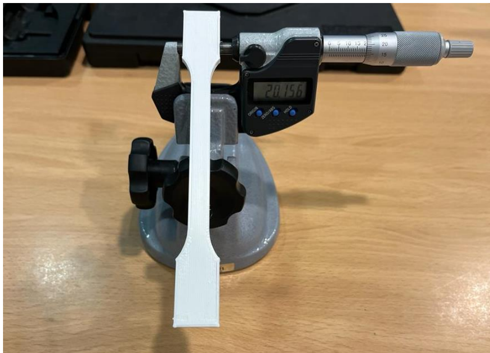
Figura 23. Muestra de medición de una probeta con micrómetro.
