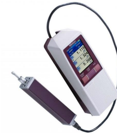
Figura 26. Rugosímetro Mitutoto SJ-210 [25].
