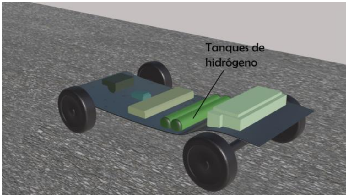
Figura 72. Interior del coche señalando tanques de hidrógeno (Fuente: elaboración propia)
