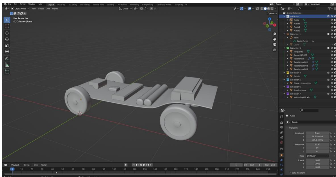
Figura 58. Estructura inferior del coche con los elementos necesarios para su funcionamiento. (Fuente: elaboración propia)
