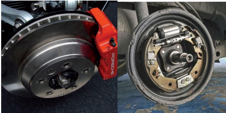
Figura 2. Freno de disco (izquierda) [3]. Freno de tambor (derecha) [9]
