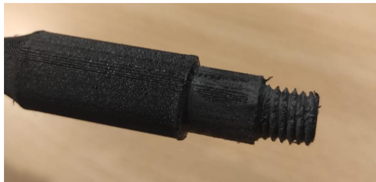
Figura 37. Roscado M10 en probeta de PLA Textura (Celulosa).
