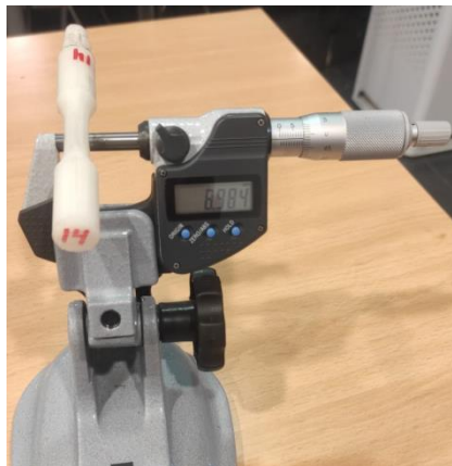
Figura 32. Control dimensional de diámetros, con micrómetro milesimal de exteriores.
