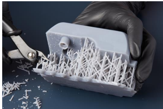
Figura 9. Eliminación manual de soportes de impresión. [12]
