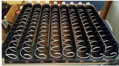
Figura 38. Bandeja de vending completa con espirales y motores
