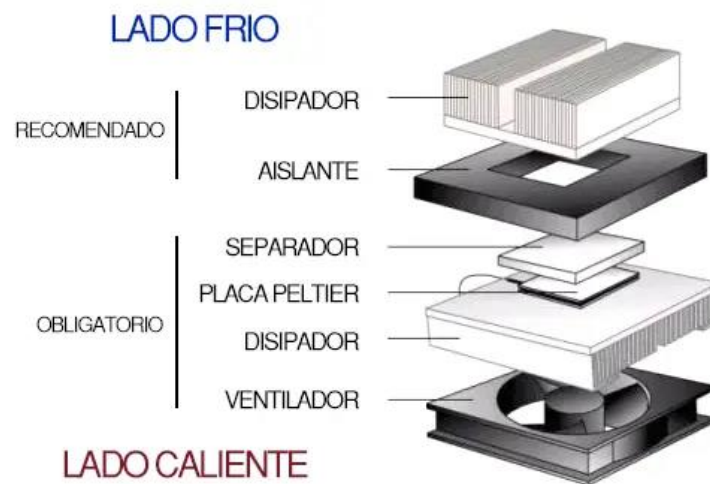
Figura 41. Partes sistema Peltier. Fuente: [36]
