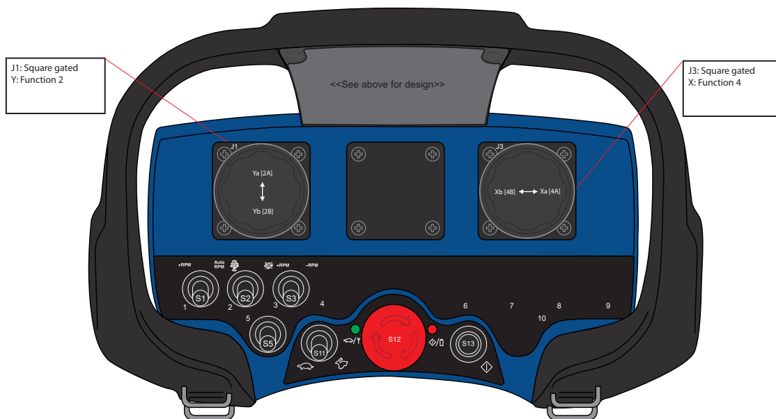
Figura 5.3: Distribución de botones en el Scanreco Mini. Fuente: [38]
