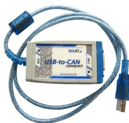
Figura 2.6: Dispositivo USB-to-CAN de IXXAT. Fuente: [12]
