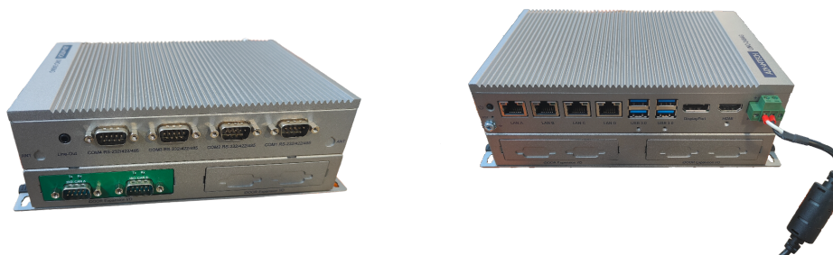
Figura 4.1: Parte delantera y trasera del PC ensamblado. Fuente: Elaboración propia.
