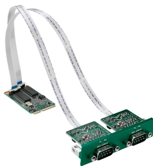
Figura 3.9: Módulo CAN PCM-26D2CA-BE con sus dos puertos DB9. Fuente: [25]
