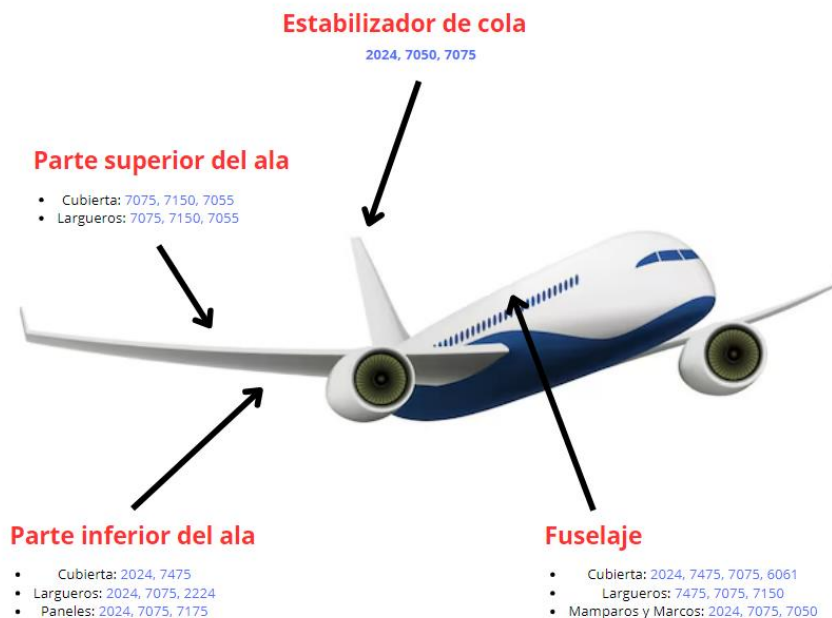
Figura 1. Aleaciones de aluminio más usadas en la fabricación de aeronaves comerciales. Adaptada de [10].
