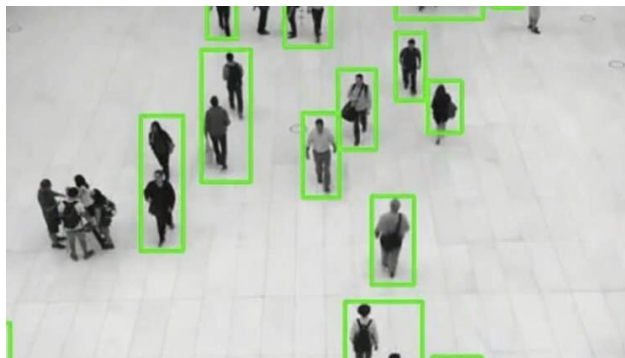
Figura 1.2: Ejemplo de detección de personas usando openCV
