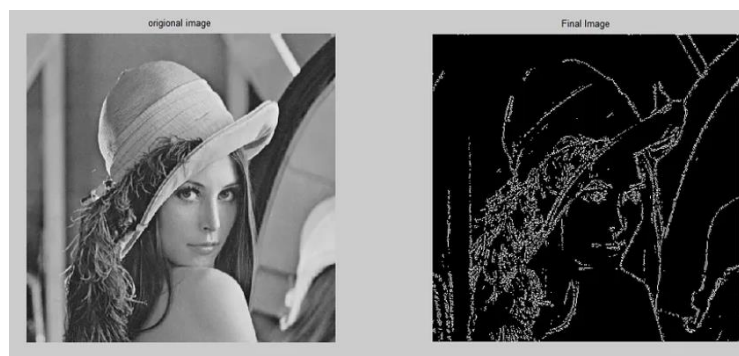
Figura 2.1: Imagen tratada con el operador Sobel
