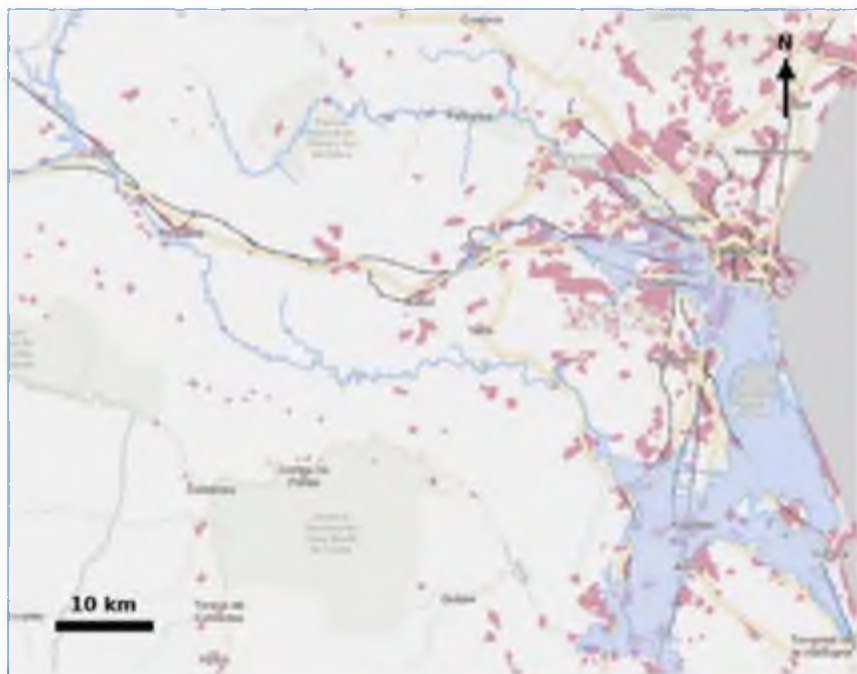
Figura 1. Disposición de las vías de comunicación (carreteras en amarillo y ferrocarriles en negro) en la zona inundada por la DANA de 29 de octubre
