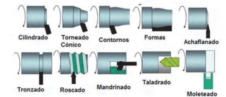
Figura 23: Operaciones de torneado [31]
