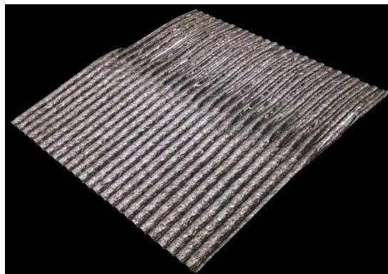
Figura 105: Costura generada en la probeta de alta calidad de HIPS
