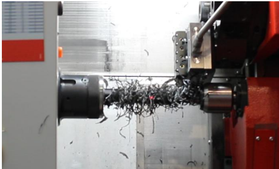
Figura 114: Probeta HIPS con enredo de viruta
