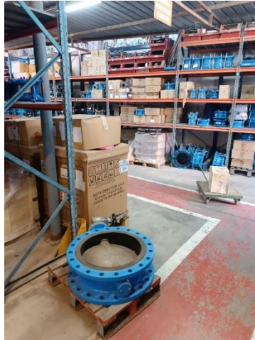
Ilustración 46. Materiales ocupando el carril de paso.
