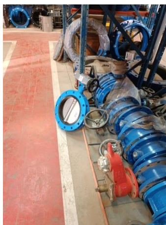
Ilustración 47. Válvula mariposa ocupando el carril de paso.
