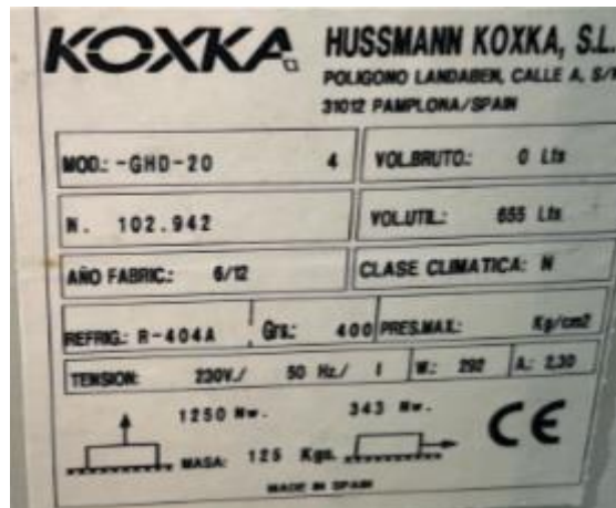
Ilustración 10. Placa de características de vitrina refrigerada.
