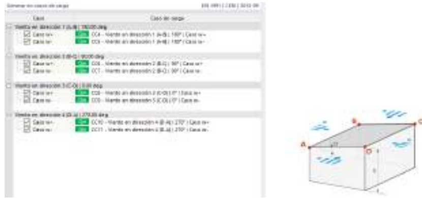
Figura 2.16: Recorte de software RFEM 6. Asistente para cargas de viento. Cubierta plana a un agua. Casos de carga.
