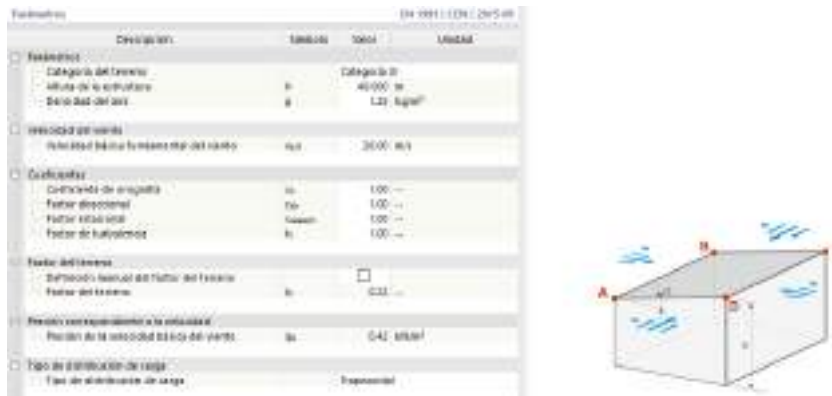
Figura 2.15: Recorte de software RFEM 6. Asistente para cargas de viento. Cubierta plana a un agua. Parámetros.
