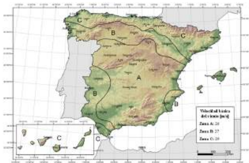
Figura 2.13: Anexo Nacional Capítulo 4 del Eurocódigo 1 [9]. Figura AN.1 - Mapa de isotacas de la velocidad básica fundamental del viento v_{b,0} .
