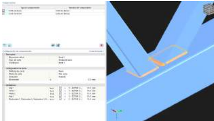
Figura 3.4: Recorte de software RFEM 6. Tipos para uniones de acero. Uniones de acero. Nudo 2149. Componentes.
