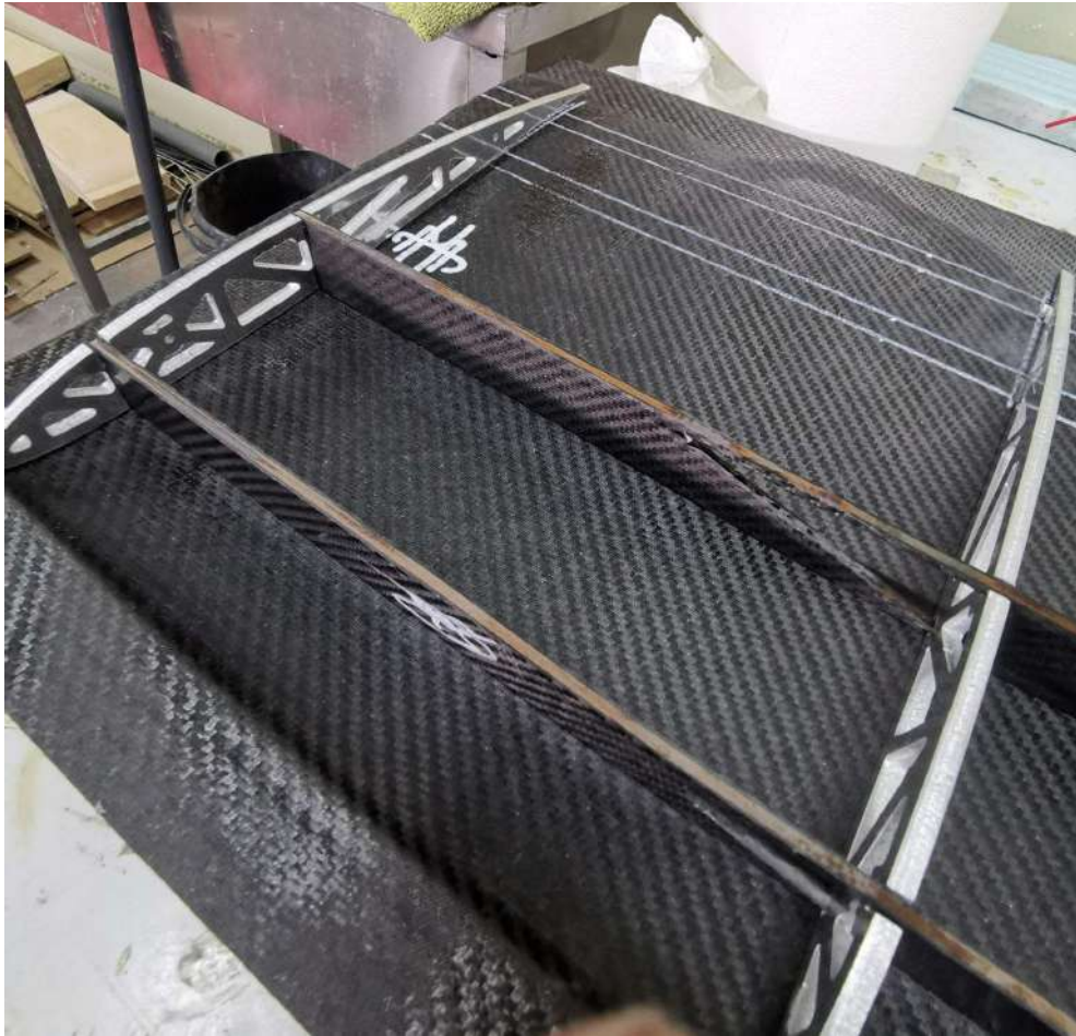
Figura 105: Vigas de CFRP con núcleo de MDF de 3mm
