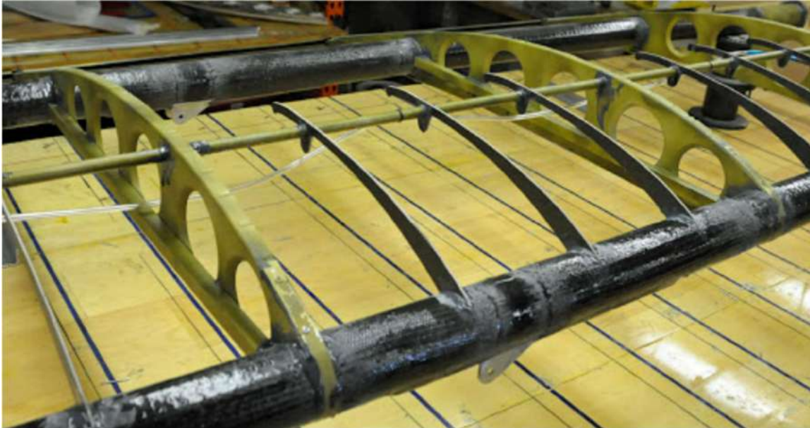
Figura 32: Ala de avión cuyo elemento estructural principal son tubos de CFRP
