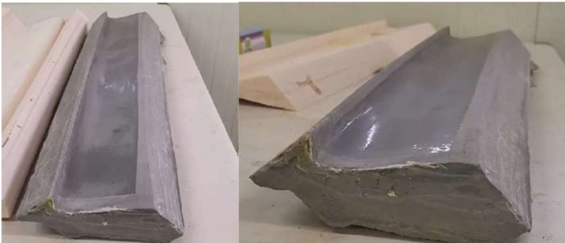
Figura 40: Moldes fabricados mediante modelo de espuma y forro adhesivo
