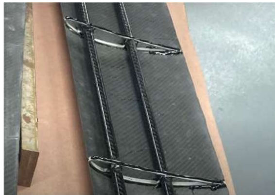
Figura 66: Perfil con tubos estructurales de CFRP
