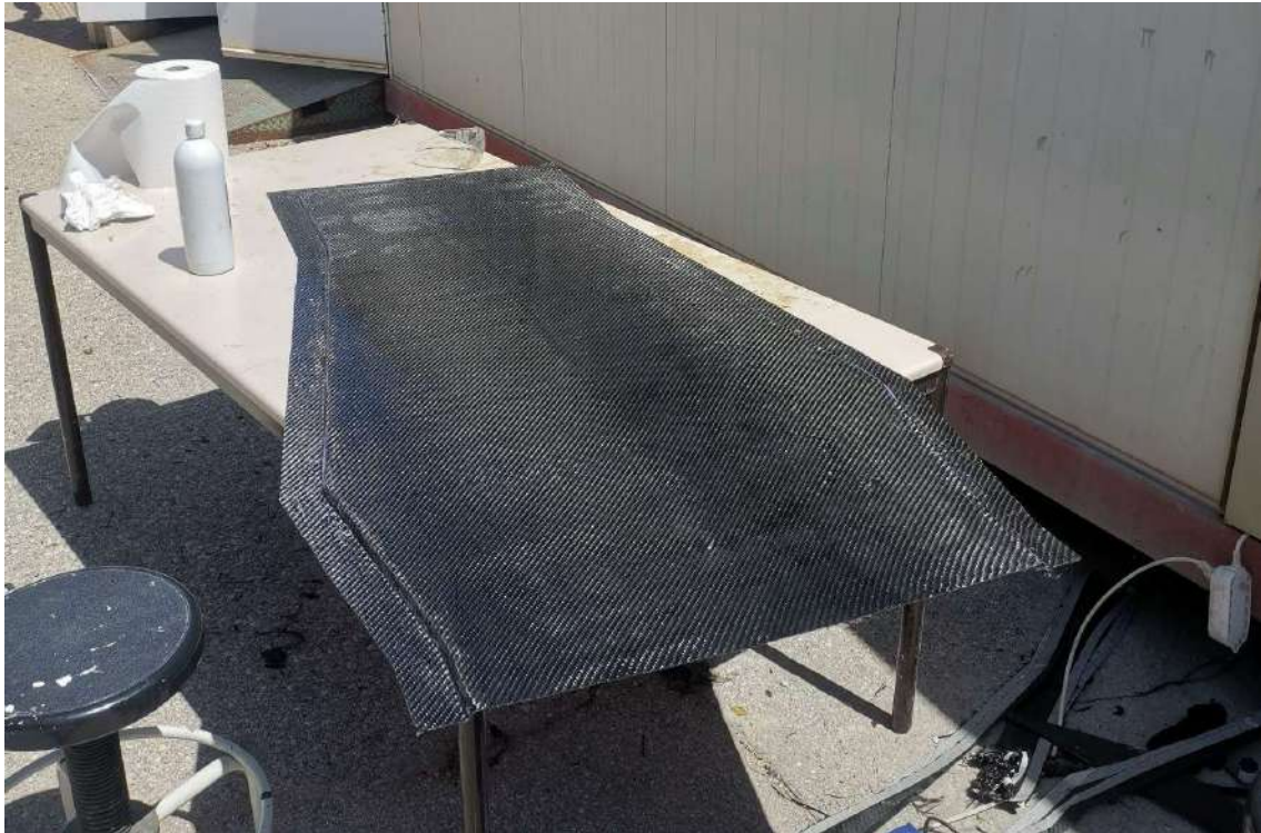
Figura 153: Recorte de los sobrantes del fondo
