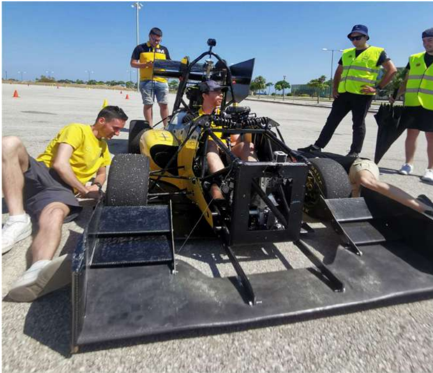
Figura 114: Tensores colocados en el alerón delantero
