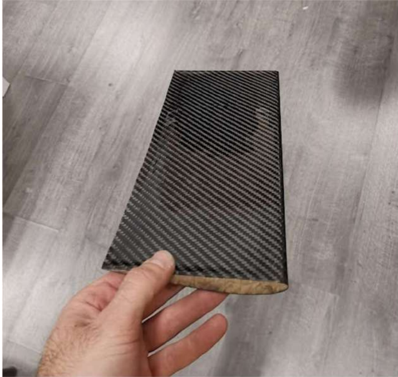
Figura 64: Perfil pequeño con núcleo de espuma
