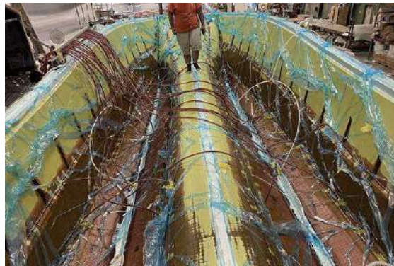
Figura 10: Proceso de infusión de resina (Penn, 2015)
