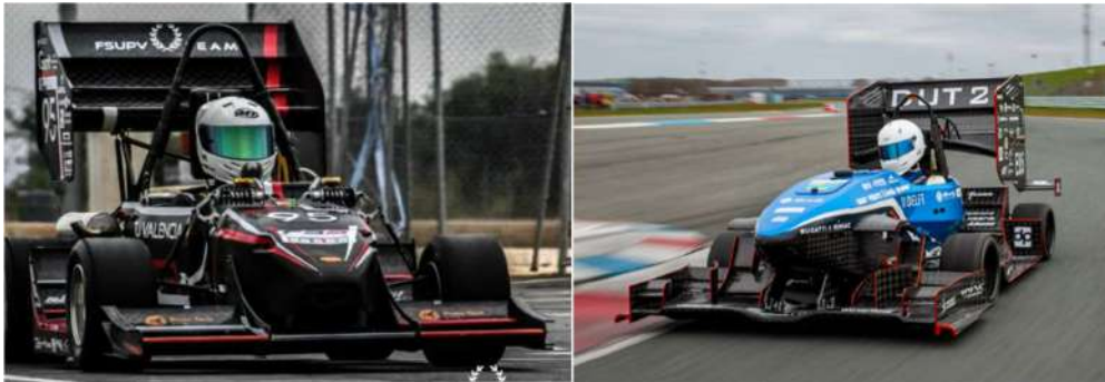
Figura 76: Alerones "rectos" (izquierda) vs alerones "curvos" (derecha)
