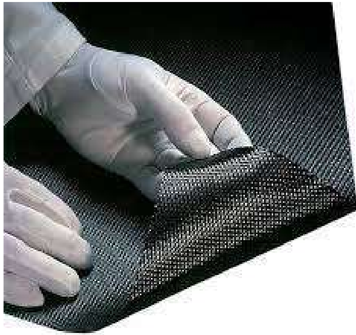
Figura 9: Colocación de fibra de carbono preimpregnada (Comseal Composite, 2025)
