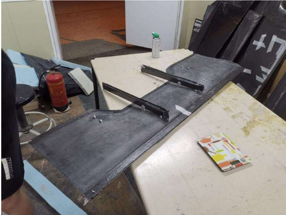
Figura 176: Montaje de las cogidas del FW en el Main
