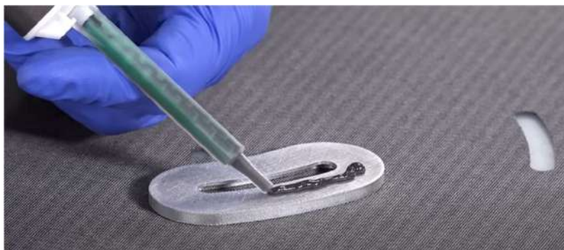
Figura 139: Adhesivado de insertos embebidos a piel de CFRP (Easy Composites Ltd., 2022)
