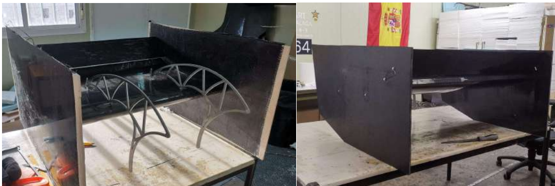
Figura 145: Montaje de los endplates en el RW
