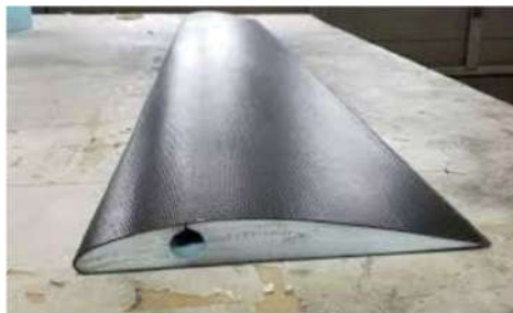
Figura 65: Sección de un perfil con core de espuma
