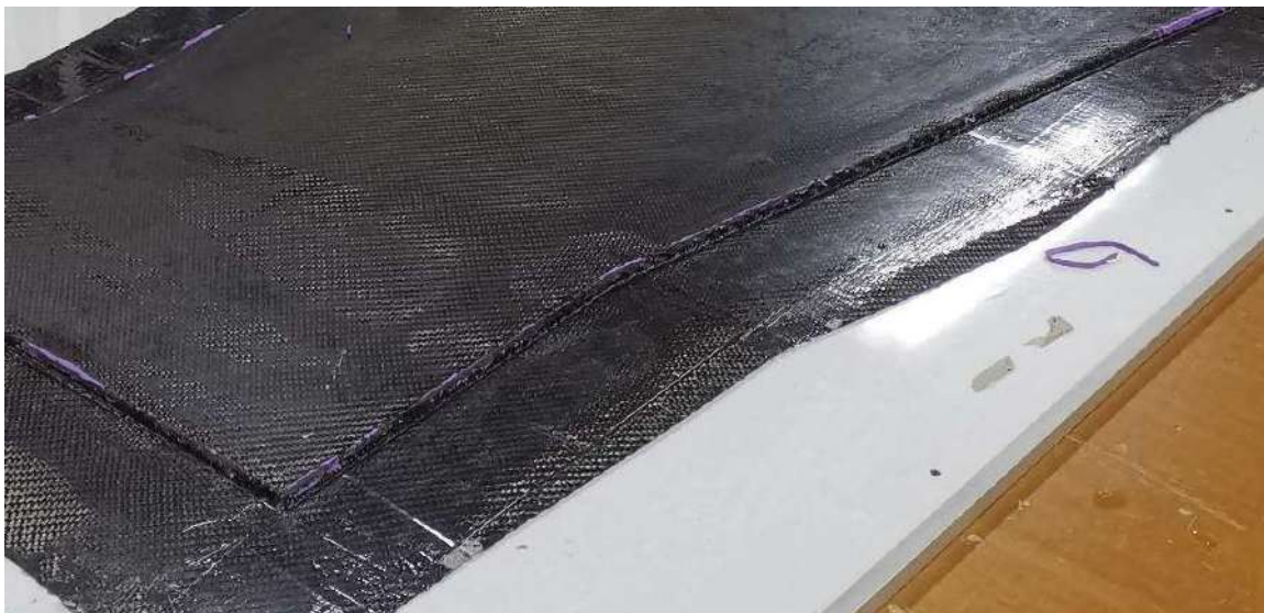
Figura 151: Zonas pobres de resina y contaminación por la plastilina
