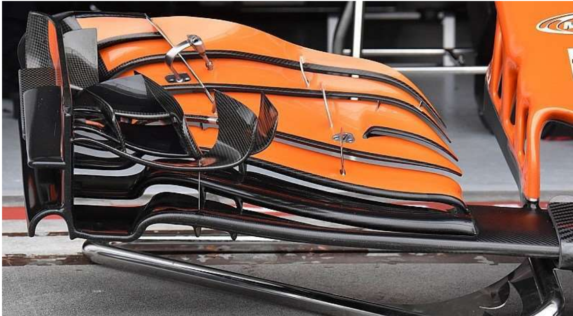
Figura 3: Alerón delantero moderno, McLaren MCL32, año 2017 (reddit, 2021)
