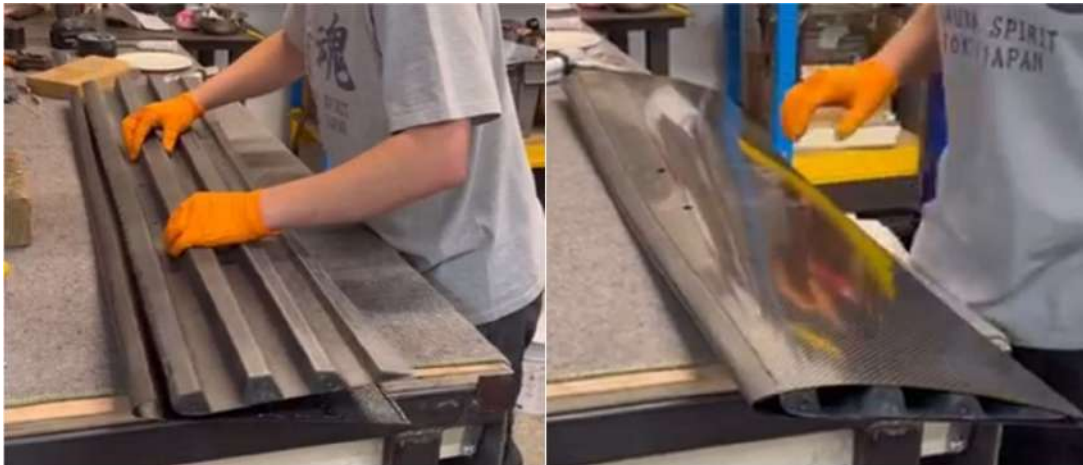
Figura 69: Montaje de perfil con estructura trapezoidal
