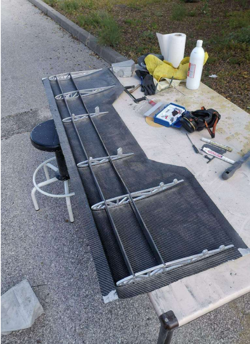
Figura 106: Montaje del FW Main I
