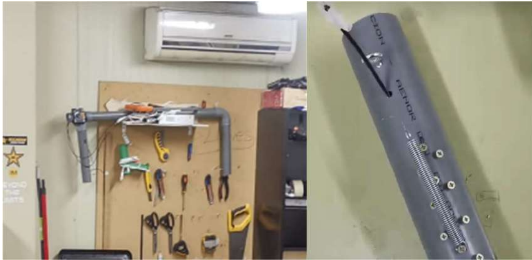
Figura 19: Cortadora de hilo caliente y su sistema de ajuste de tensión
