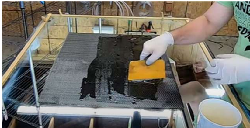
Figura 90: Laminado sobre un vidrio
