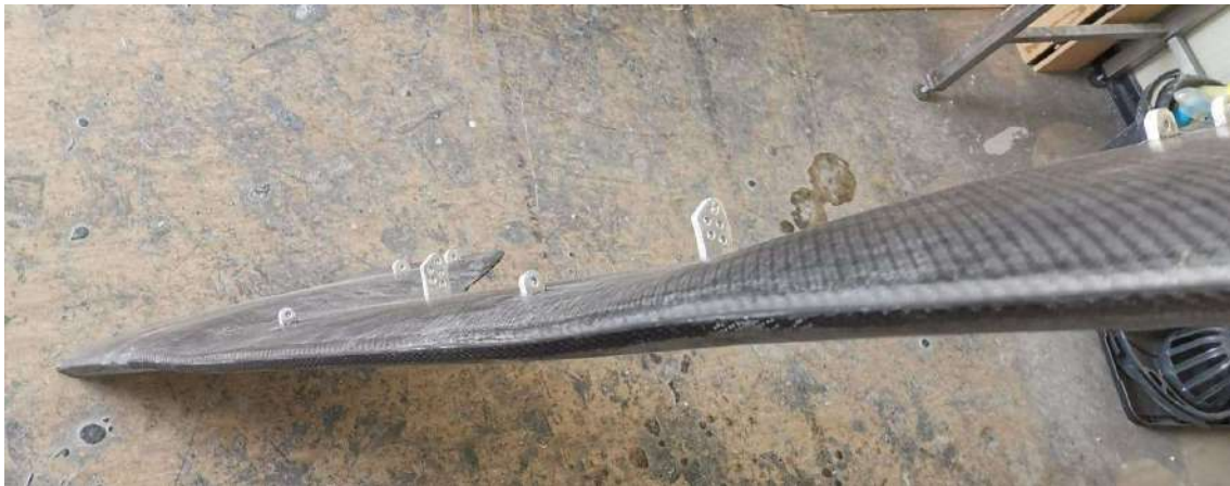
Figura 109: FW Main montado detalle del leading edge
