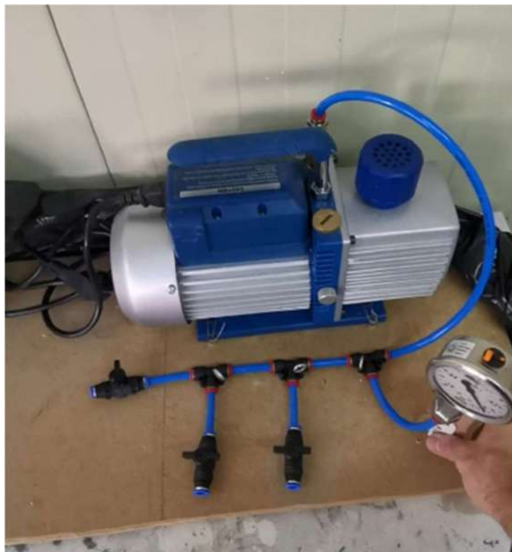
Figura 20: Instalación de vacío
