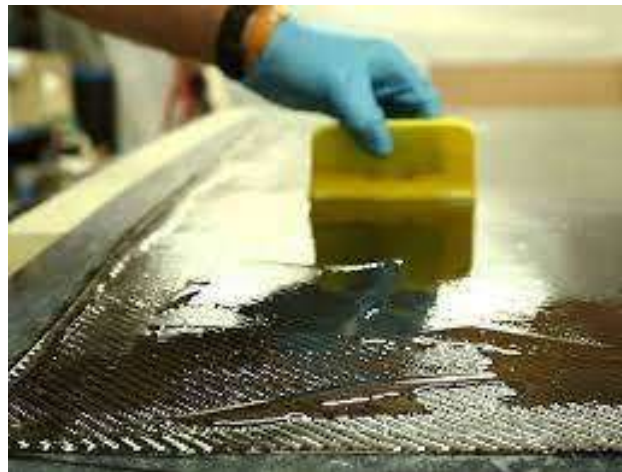
Figura 11: Laminado húmedo (Total Boat, 2025)
