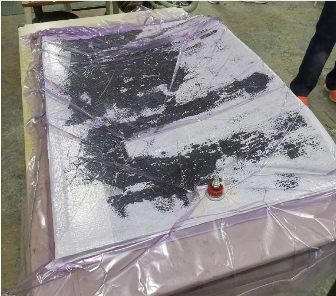
Figura 161: Laminado del difusor sobre molde de cemento
