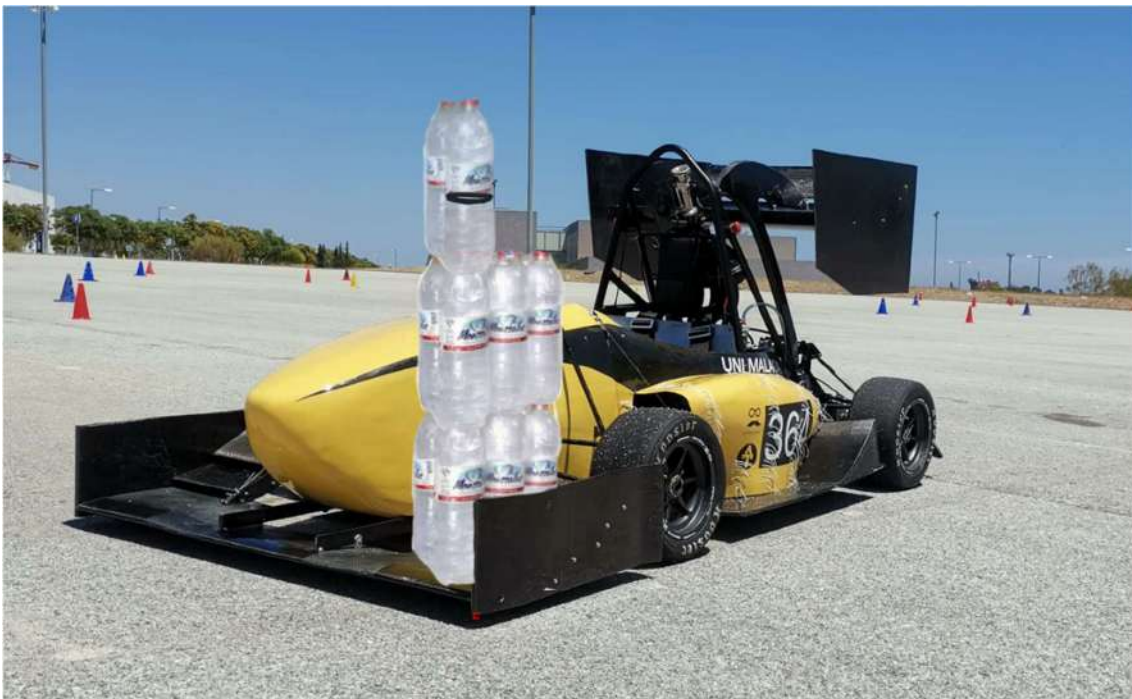
Figura 120: Recreación de la prueba de rigidez realizada
