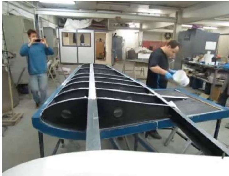
Figura 30: Ala de avión fabricada en composite con estructura interna
