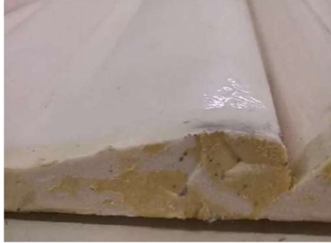
Figura 41: Arrugas apreciadas en el forro después de sacar el modelo del molde
