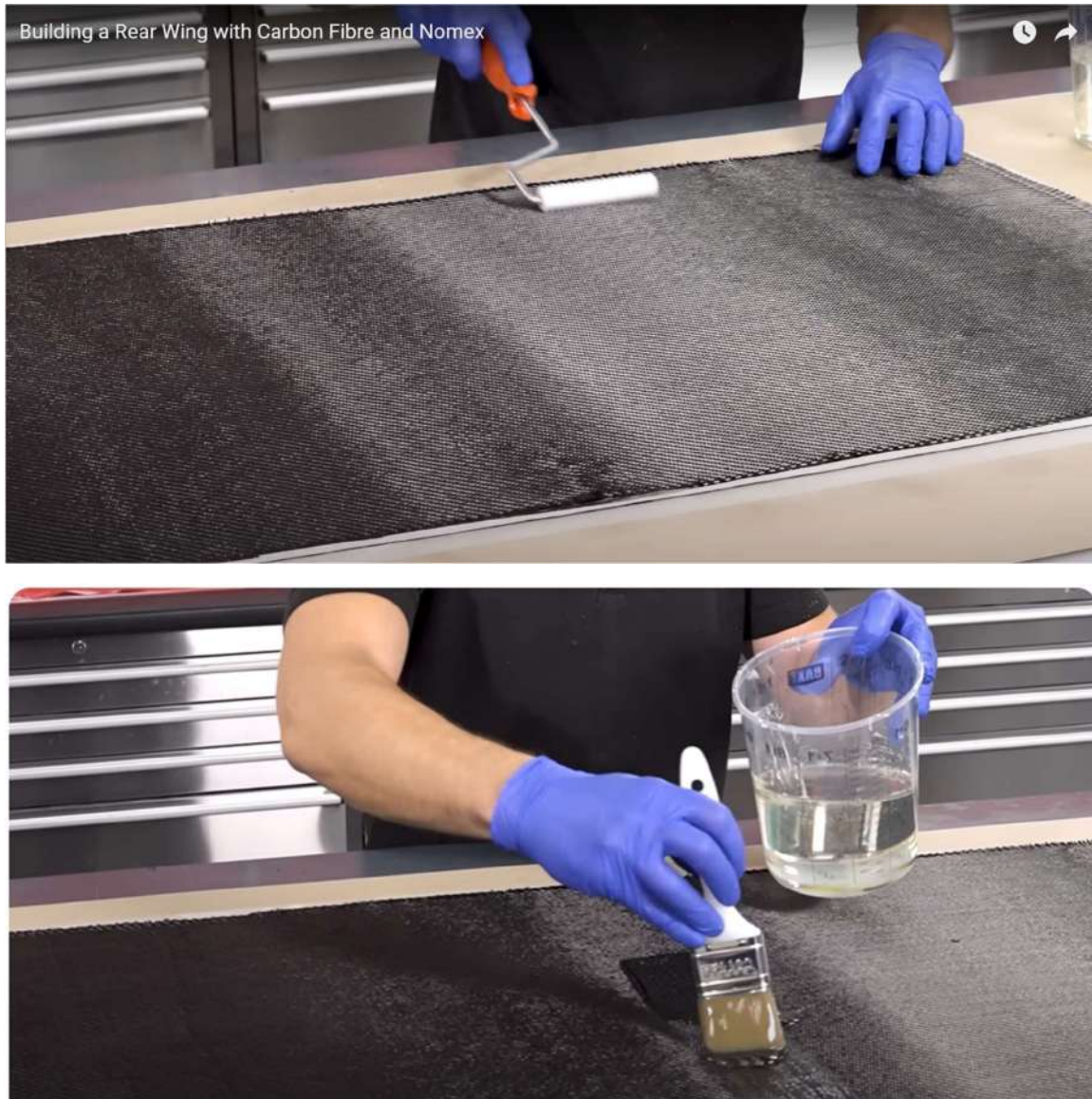
Figura 128: Compactación mediante rodillo y siguiente capa aplicación de resina (Easy Composites Ltd., 2022)
