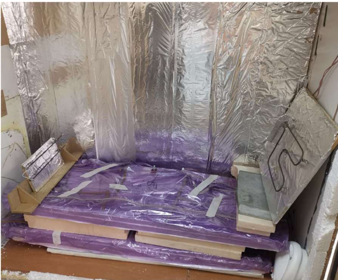
Figura 22: Interior del horno con dos piezas del alerón delantero dentro
