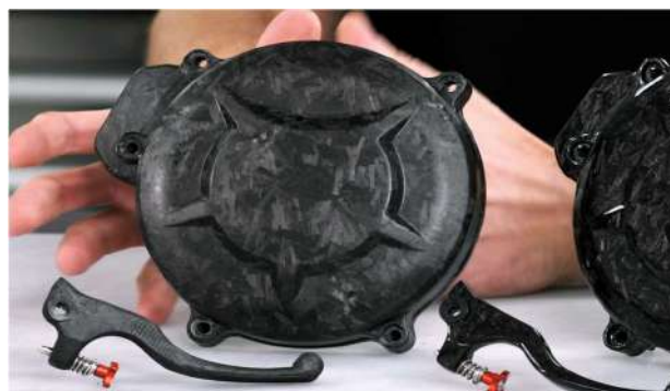
Figura 31: Tapas de transmisión y manetas de moto fabricadas en carbono forjado
