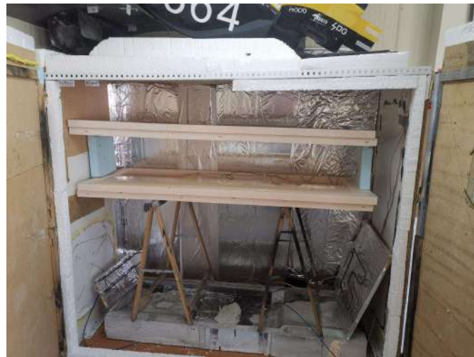
Figura 95: Curado en horno de las capas de resina
