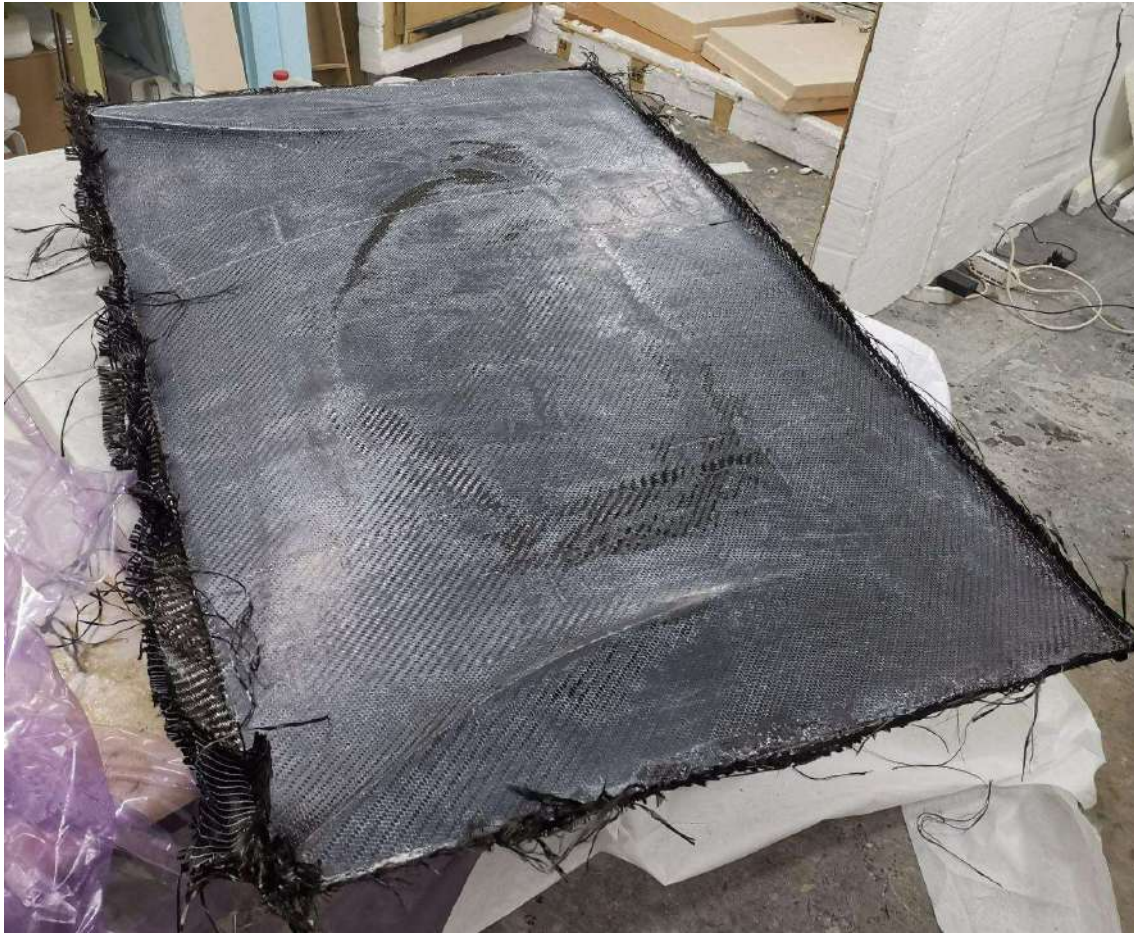
Figura 162: Difusor desmoldado, superficie inferior
