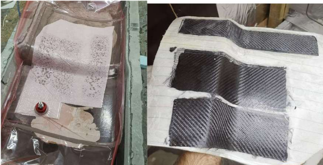
Figura 60: Prueba de desmoldeo
