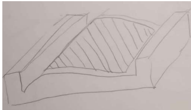
Figura 38: Concepto de moldeo sobre espuma con film adhesivo
