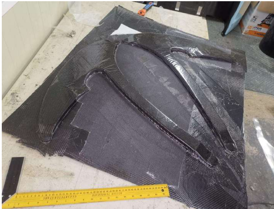
Figura 180: Cogidas definitivas del RW desmoldadas
