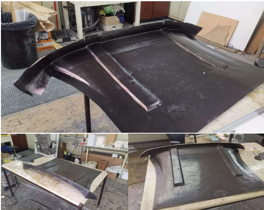
Figura 164: Laminado del Gurney flap en el difusor
