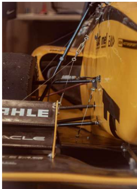
Figura 167: Múltiples tensores en el monoplaza
