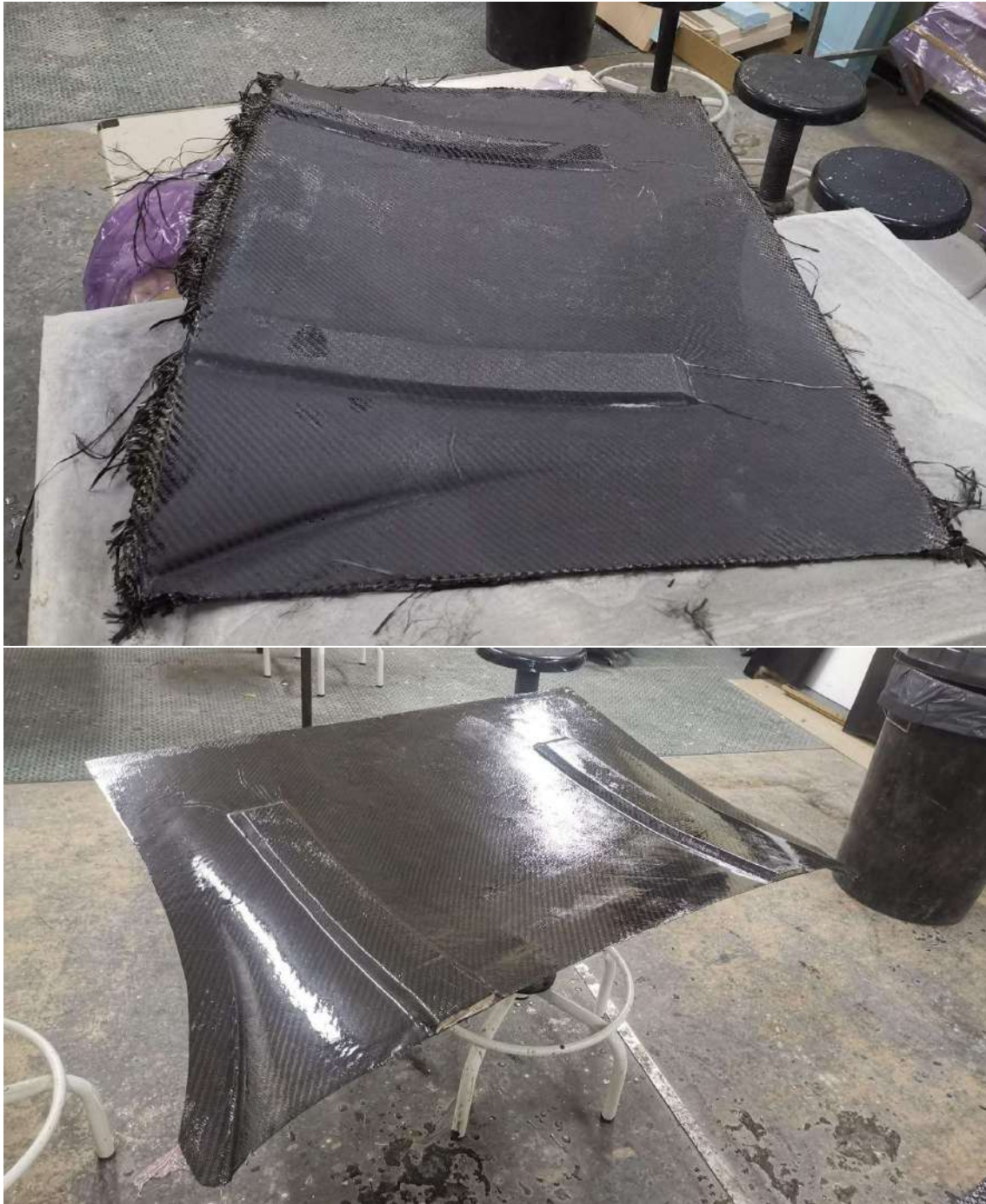
Figura 163: Superficie superior del difusor
